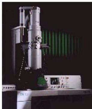
**Figure 84 : Microscope électronique à transmission CM12, Philips utilisé pour l'observation des grilles. La source d'électrons est une cathode en hexaborure de lanthane (LaB<sub>6</sub>). La tension de travail est 120 kV.**
