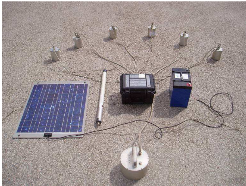
FIG. 2.4 – Une nappe du réseau IHR. Chaque nappe comprend 6 capteurs verticaux, 1 capteur 3 composantes, 1 station d'acquisition, 1 antenne WiFi, 1 GPS, 1 panneau solaire et 1 batterie.
