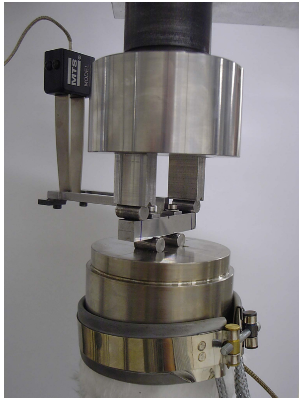
Figure 95 : Montage expérimental permettant la réalisation d'essais de fatigue propagation en présence de métal liquide.
