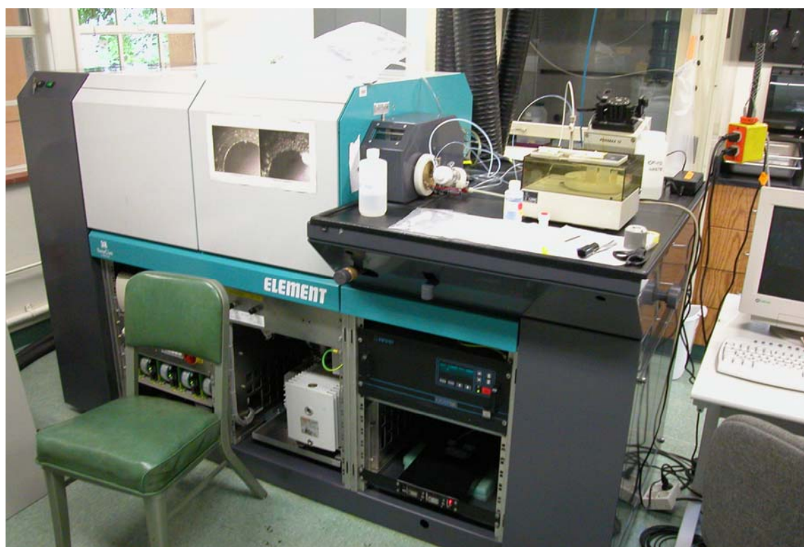
Fig. AIII.5 : photographie de l'ICP-MS utilisé pour les datations U-Th/He au laboratoire de CALTECH
