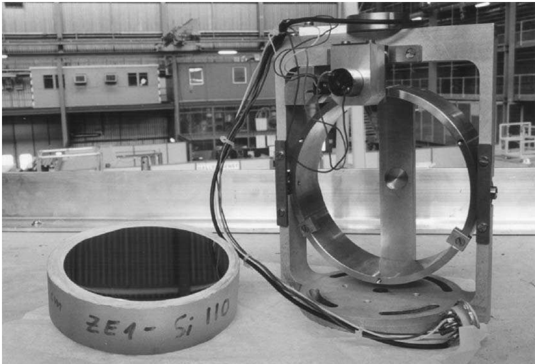
Figure 2-9: Un cristal courbe de silicium avec son support.
