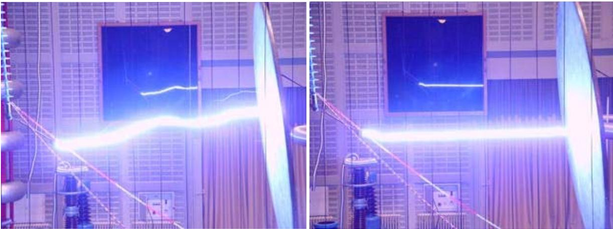
Fig. 5.1 – décharge non-guidée (sans laser)
