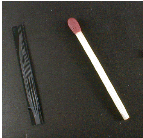
Figure VIII-1 - Optique intégrée recombinaison de trois voies en configuration multi-axiale
