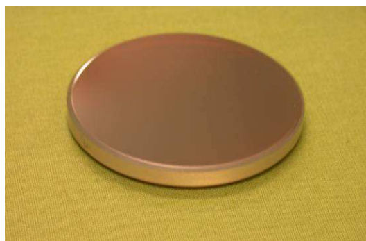
FIG. 6.2: Photographie d'un échantillon de couche épaisse de ZnSe sur un substrat de ZnS. Le substrat présente une épaisseur de 5 mm et un diamètre de 50 mm.
