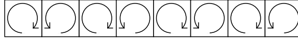
FIG. III.5 – : Schéma représentant l'apparition de courants spontanés alternés, caractéristiques d'une phase de flux, sur une échelle à deux montants.
