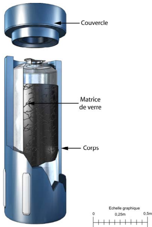
Figure 1-5 :Schéma d'un colis de stockage de déchets vitrifiés avec un surconteneur en acier non allié
