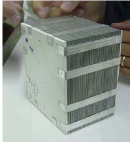
FIG. 3.8 – Emballage mécanique des briques OPERA, à l'aide de matériaux adhésifs de grande résistance.
