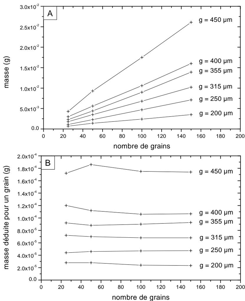
FIGURE. A7.2 - **Illustration A** : vérification de la proportionnalité entre la masse mesurée et le nombre de grains utilisés. **Illustration B** : nombre de grains nécessaires pour assurer la convergence de la masse mesurée.
