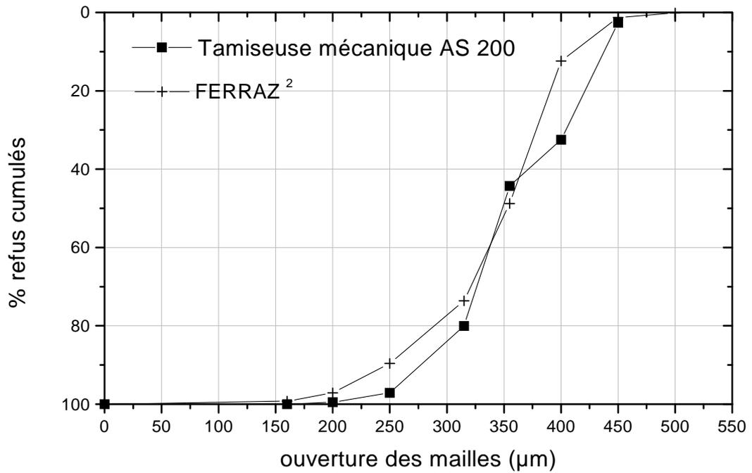
FIGURE 3.6 – Analyse granulométrique du sable de silice.
