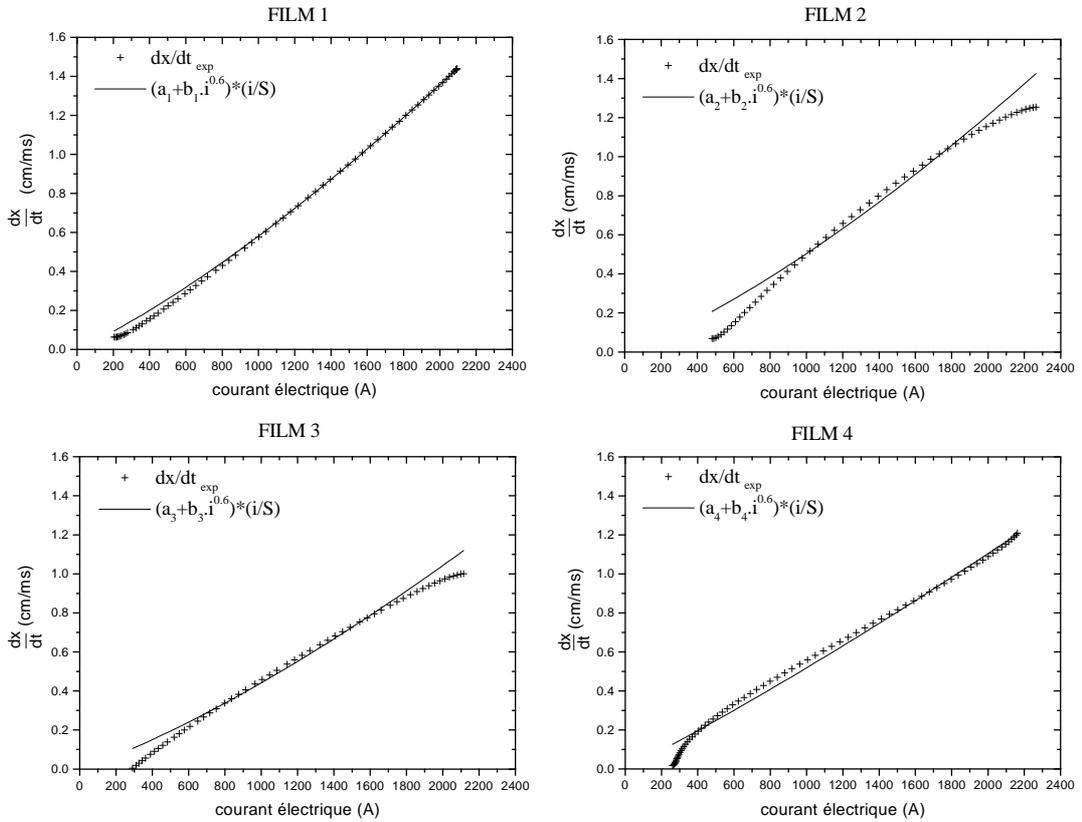
FIGURE 5.11 – Représentation de la linéarité entre la vitesse de "burn-back" et le courant électrique. Les courbes de tendance sont de la forme :  $\frac{dx}{dt} = f(i) = a_n + b_n i^{0.6}$ , où  $n = 1, 2, 3, 4$  représente le numéro du film, et  $S$  est la section de l'élément fusible ( $5 \cdot 10^{-3} \times 0,105 \cdot 10^{-3} m^2$ ).
