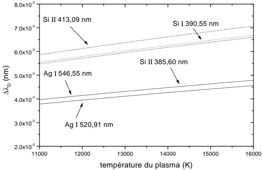
FIGURE 2.6 – *Elargissement Doppler : évaluation de la largeur totale à mi-hauteur pour les transitions Ag I (520,91 nm), Ag I (546,55 nm), Si I (390,55 nm), Si II (385,60 nm), Si II (413,09 nm).*
