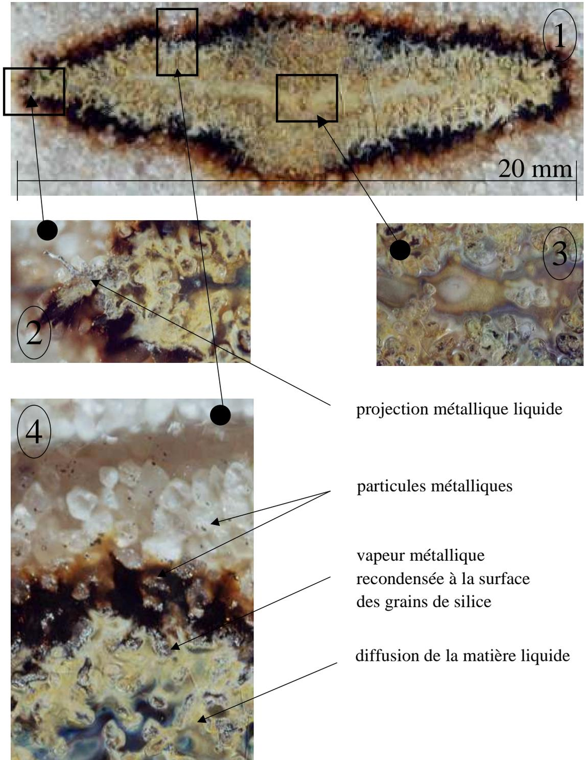
FIGURE 1.5 – *Détail de la structure de la fulgurite.*
