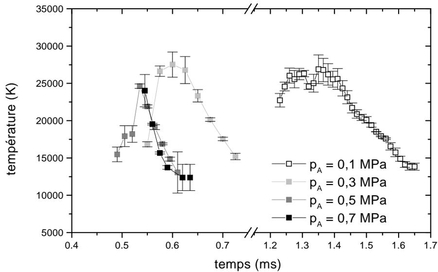
FIGURE 4.13 – *Evaluation de la température dans le plasma d'arc créé par décharge capacitive sur les fils en cuivre, pour les quatre pressions de tests.*
