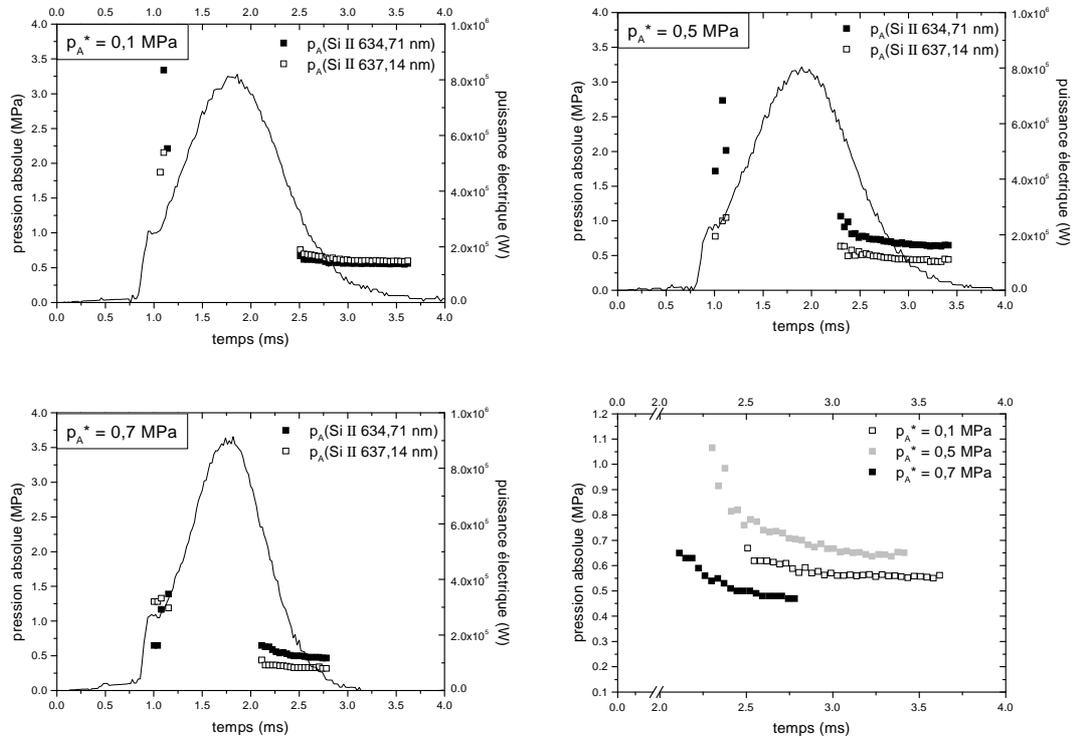
FIGURE 4.26 – Application des coefficients  $k_{P,p_A}$  à la détermination de la pression dans le plasma d'arc de fusible pendant le mécanisme de coupure. Les pressions absolues repérées par  $*$  sont les valeurs utilisées dans l'étude de l'influence d'une surpression dans la matière de remplissage.
