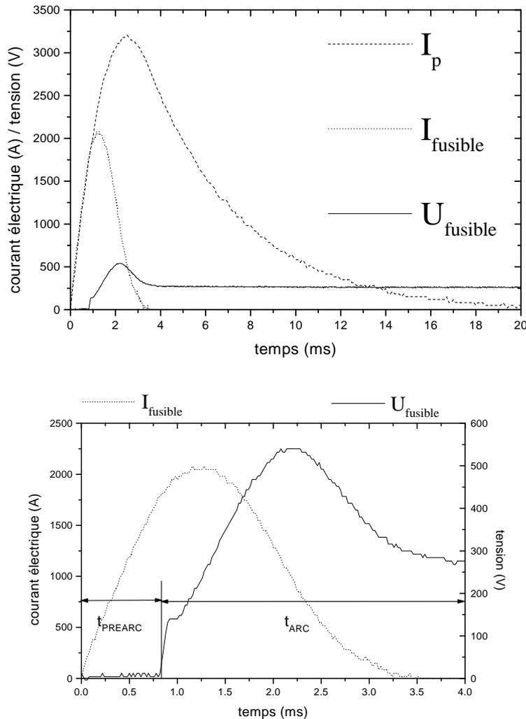
FIGURE 1.2 – Illustration du rôle du fusible : interruption du courant de défaut présumé  $I_p$ , et évolution du courant  $I_{fusible}$  induit par le fusible et de la tension  $U_{fusible}$  aux bornes du fusible. La somme des durées des deux régimes de fonctionnement définit la durée totale de fonctionnement :  $t_{TOT} = t_{PREARC} + t_{ARC}$ . Les caractéristiques sont issues de tests réalisés au laboratoire.
