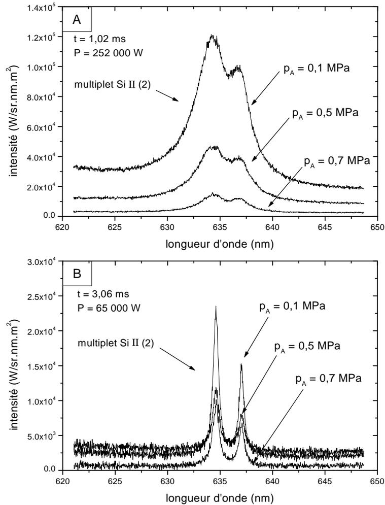
FIGURE 4.4 – Profils des raies du multiplet *Si II (2)* en fonction de la puissance électrique et de la surpression dans les interstices. Illustration A : profils observés en début de phénomène. Illustration B : profils observés en fin de phénomène.
