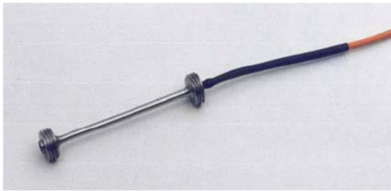
Figure 1-14 : Jauge de Fabry-Pérot à immerger dans le béton.
