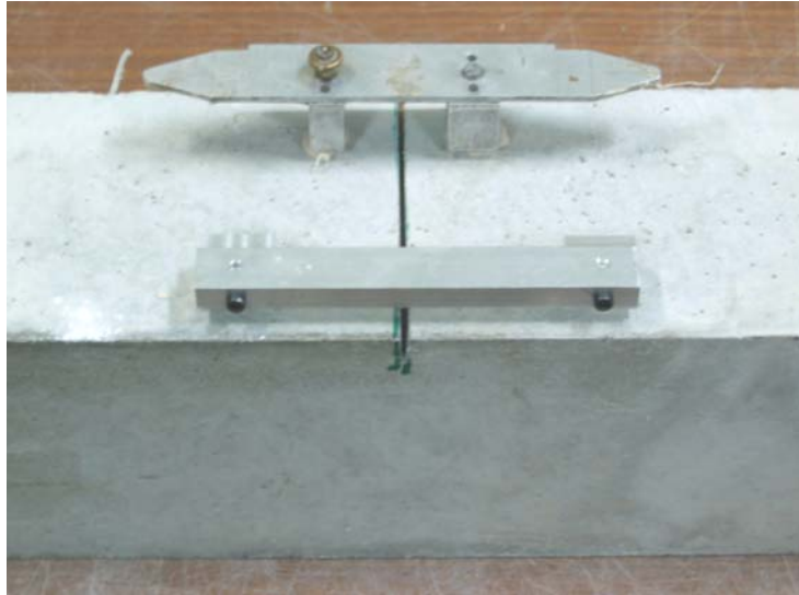
Figure 4-20 : Alignement des plots d'ancrage par des équerres.
