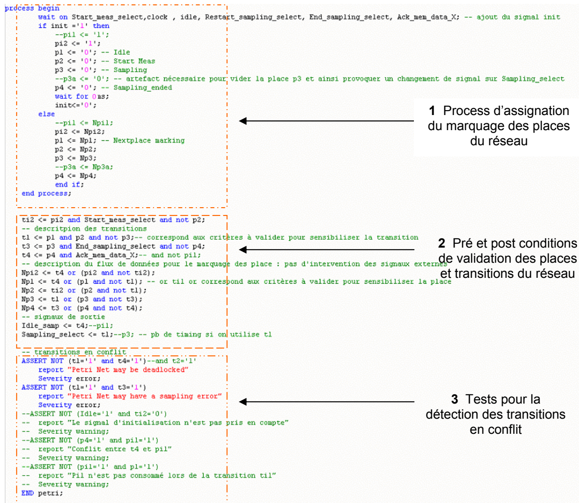
Figure 3-2 : Description du RdP de la structure interne du bloc MTAnalyse (niveau 3) par la méthode ConPar.
