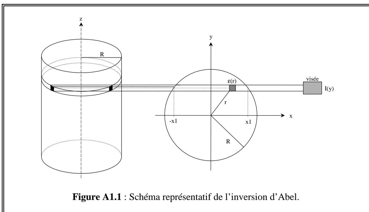
**Figure A1.1** : Schéma représentatif de l'inversion d'Abel.
