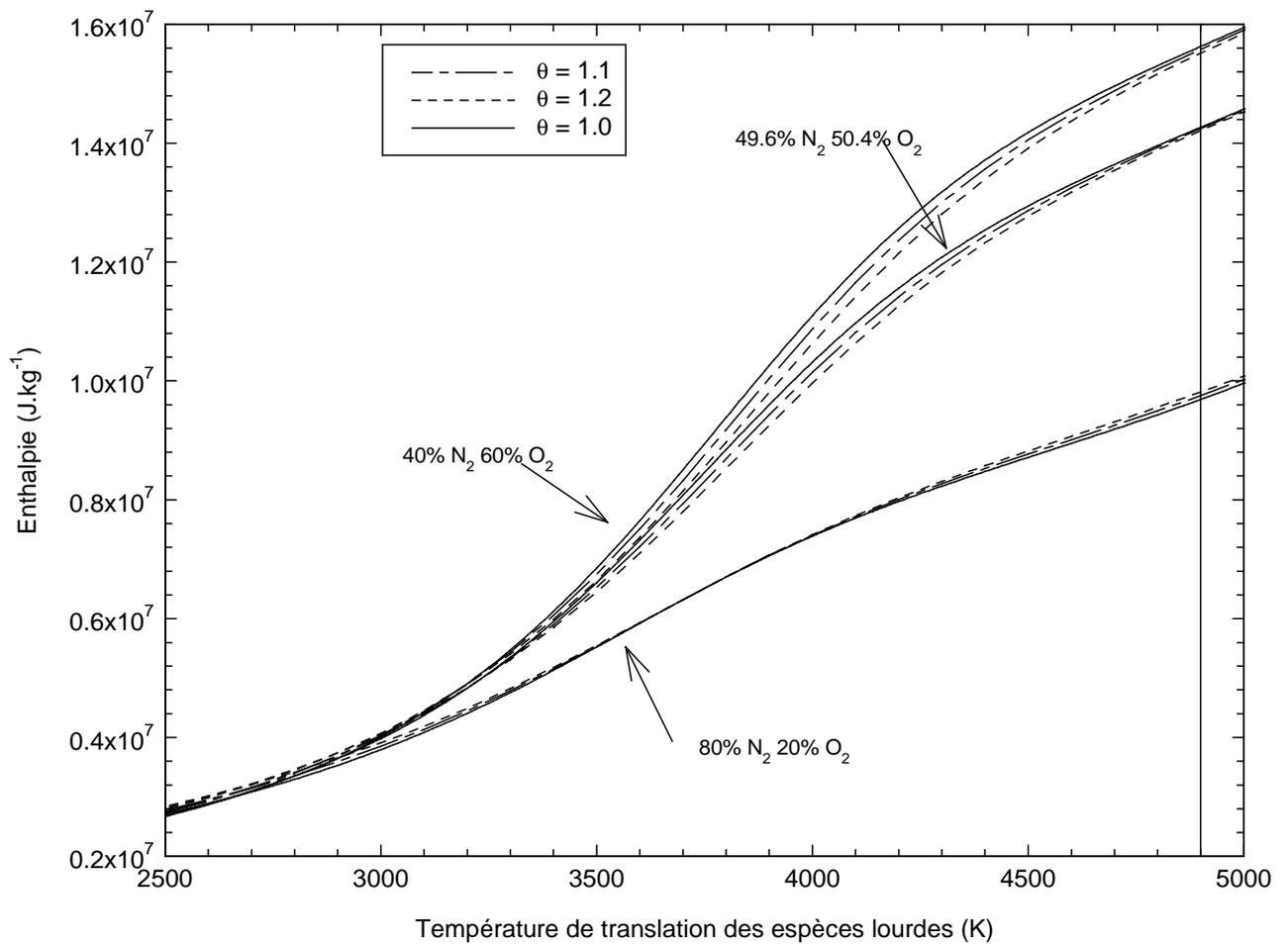
**Figure 4.14** : Comportement de l'enthalpie massique en fonction de la température de translation des espèces lourdes (hypothèse 2) pour les différents mélanges de  $\text{N}_2$  et  $\text{O}_2$  en présence d'aérosol (0,4%) sous trois valeurs du degré de déséquilibre thermique.
