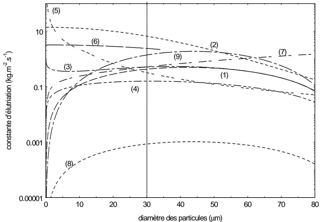
**Figure 2.3 :** Evolution de la constante d'éluvation en fonction du diamètre des particules pour une vitesse de gaz fluidisant égale à  $0,5 \text{ m.s}^{-1}$ . (1) Wen et Hashinger [WEN-60] ; (2) Geldart [GEL-86] ; (3) Yagi et Aochi [YAG-55] ; (4) Wen et Chen [WEN-82] ; (5) Zenz et Weil [ZEN-58] ; (6) Baeyens et al. [BAE-92] ; (7) Li et Kato [LI-01] ; (8) Rodríguez et al. [ROD-00] ; (9) Ma et Kato [MA-98].
