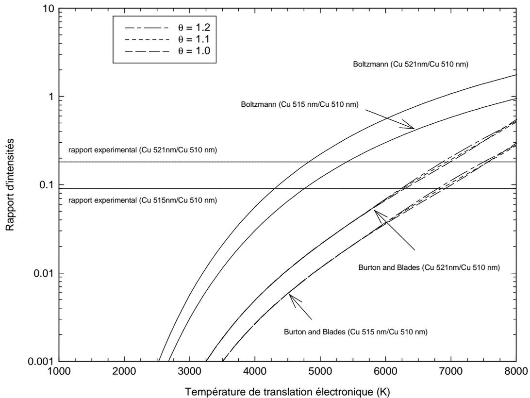
**Figure 4.10a** : Evolution des rapports d'intensités, selon la méthode de Boltzmann et la correction de Burton et Blades, en fonction de la température de translation électronique (hypothèse 1) et du degré de déséquilibre thermique.
