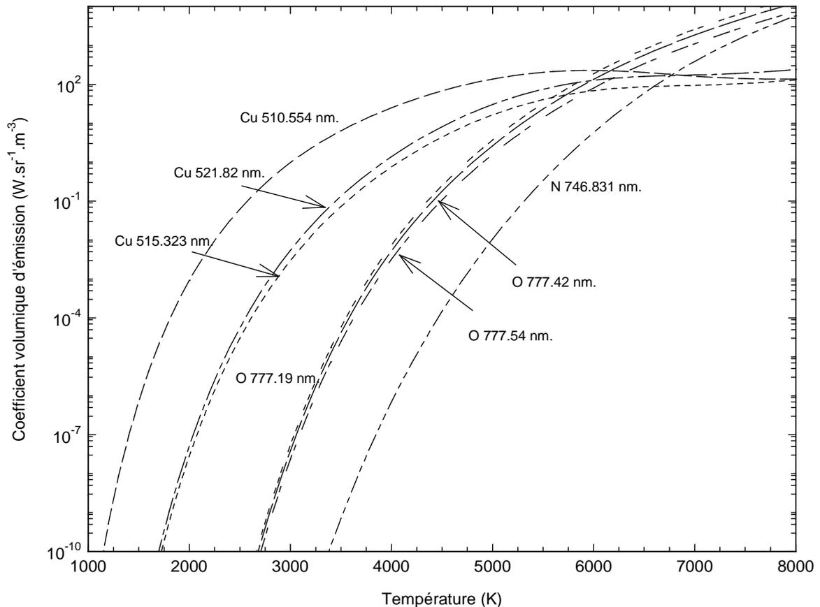
**Figure 4.11 :** Evolution du coefficient volumique d'émission de raies spectrales du cuivre, de l'azote et de l'oxygène dans un plasma formé de 99,6% de mélange 3 et 0,4% d'aérosol, en fonction de la température à l'équilibre thermique et suivant une distribution de Boltzmann.
