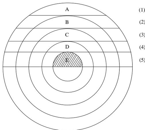
**Figure A1.2 :** Méthode géométrique pour l'inversion d'Abel.
