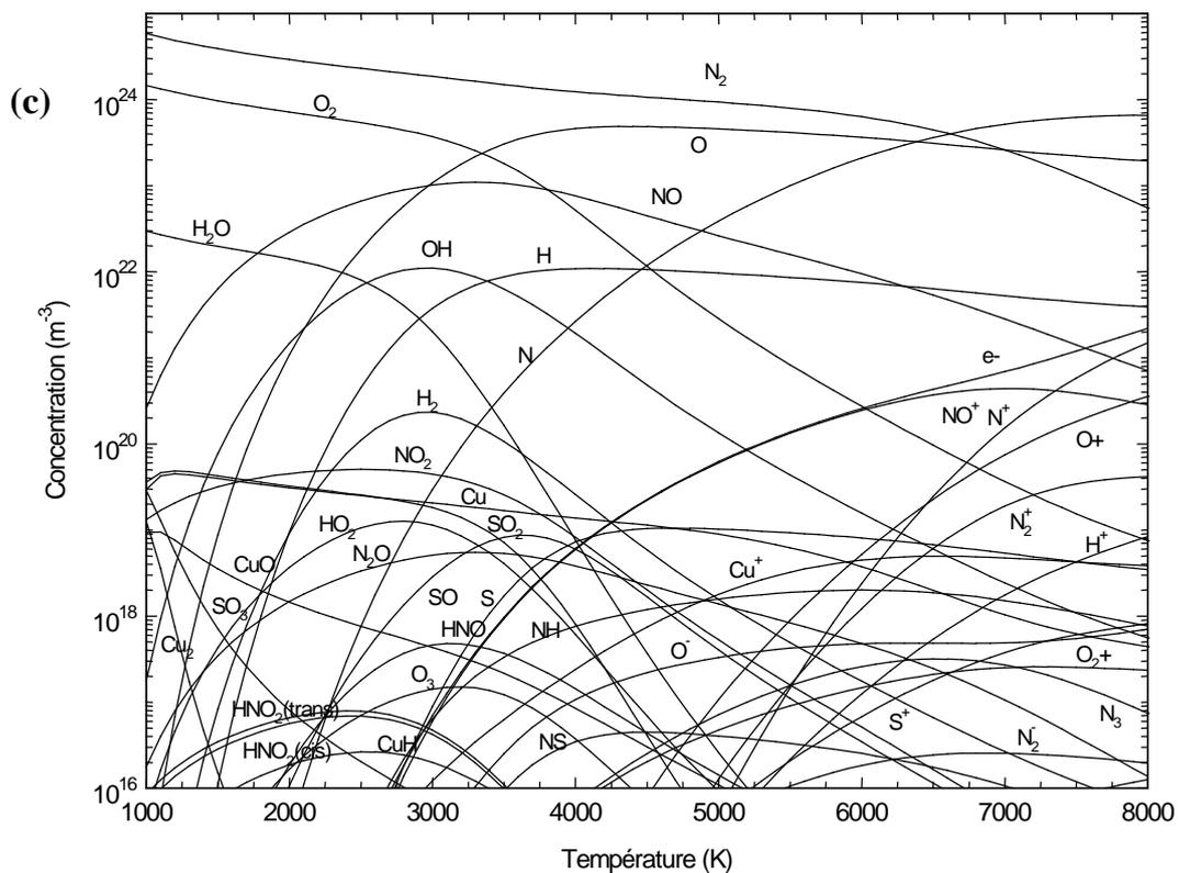
**Figure 4.7 :** Composition du plasma à l'équilibre thermique et à la pression atmosphérique en fonction de la température. (a) 99,6% de mélange 1 et 0,4% d'aérosol ; (b) 99,6% de mélange 2 et 0,4% d'aérosol ; (c) 99,6% de mélange 3 et 0,4% d'aérosol.
