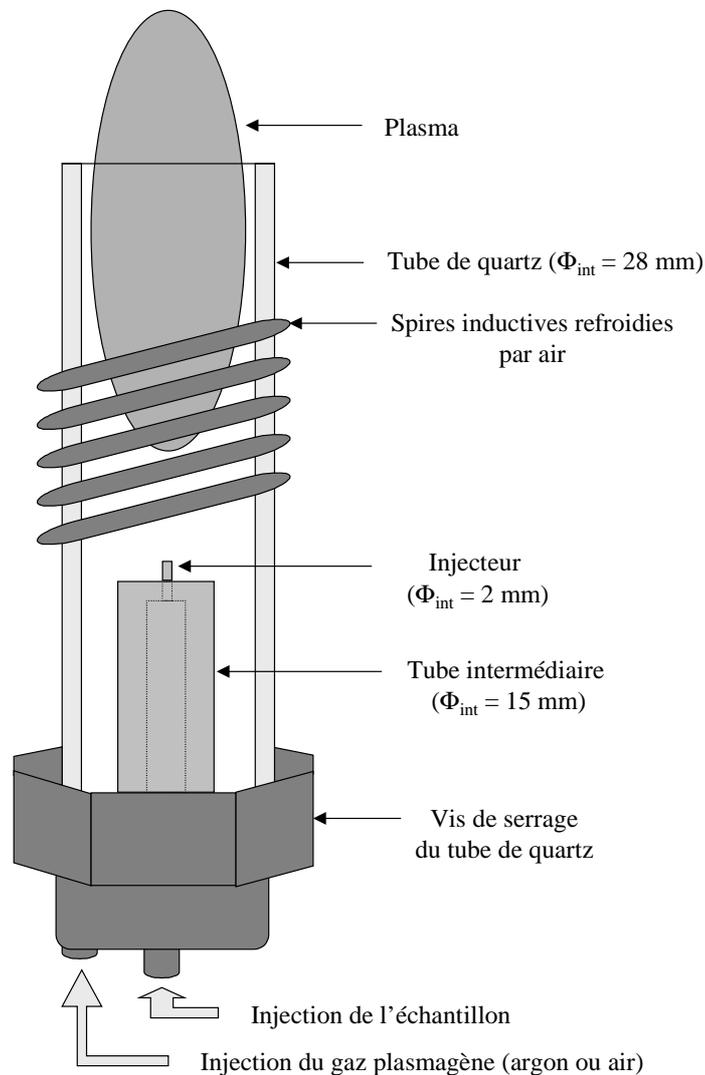
**Figure 3.2** : Schéma de principe de la torche à plasma ( $\Phi_{\text{int}}$  : diamètre interne).
