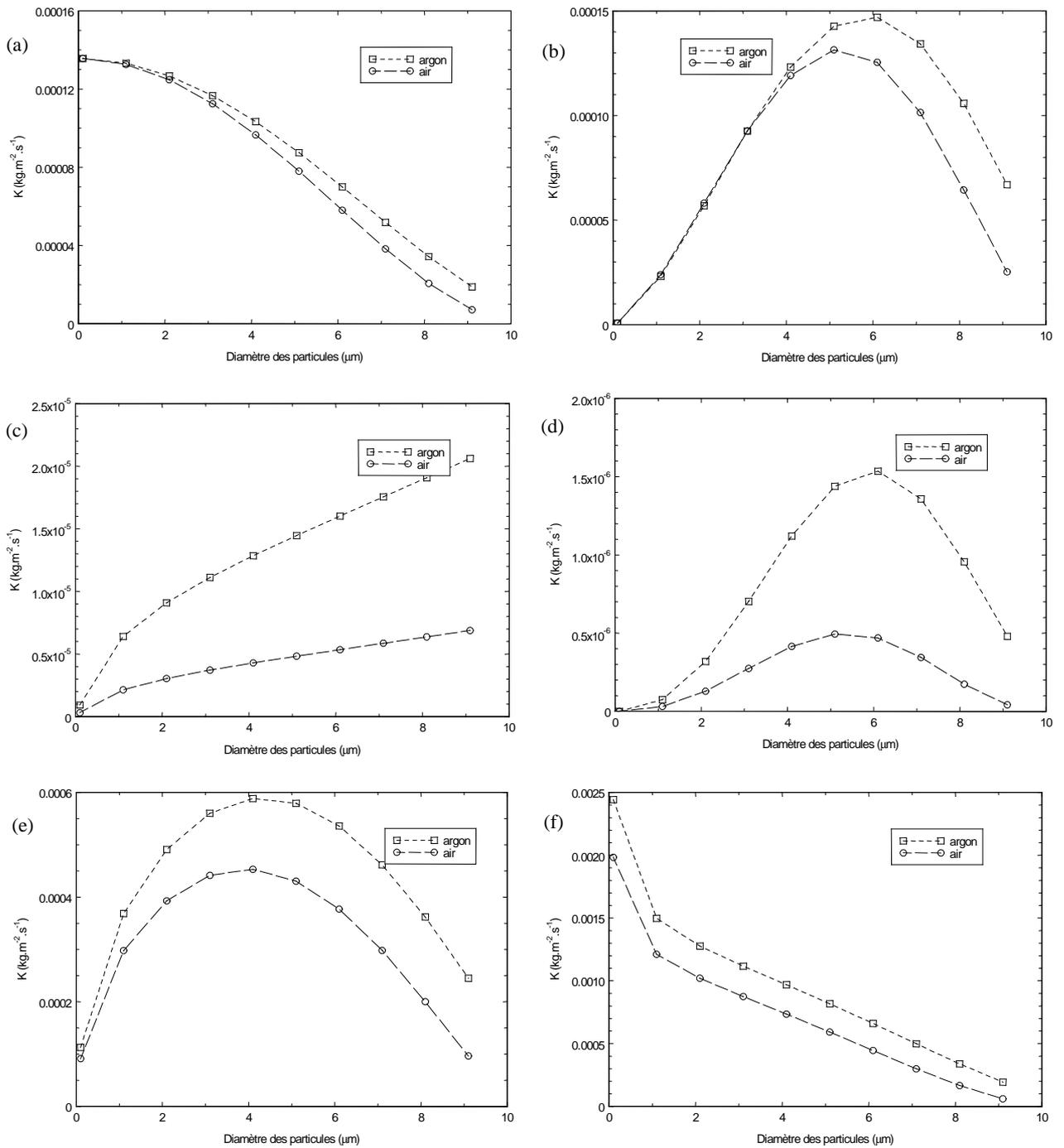
**Figure 2.4 :** Evolution de la constante d'élutriation en fonction du diamètre des particules et de la nature du gaz fluidisant. Exemple de particules de CuO pour une vitesse de gaz fluidisant égale à  $0,02 \text{ m.s}^{-1}$ . (a) formule de Baeyens et al. [BAE-92] ; (b) formule de Wen et Hashinger [WEN-60] ; (c) formule de Li et Kato [LI-01] ; (d) formule de Ma et Kato [MA-98] ; (e) formule de Wen et chen [WEN-82] ; (f) formule de Yagi et Aochi [YAG-55].
