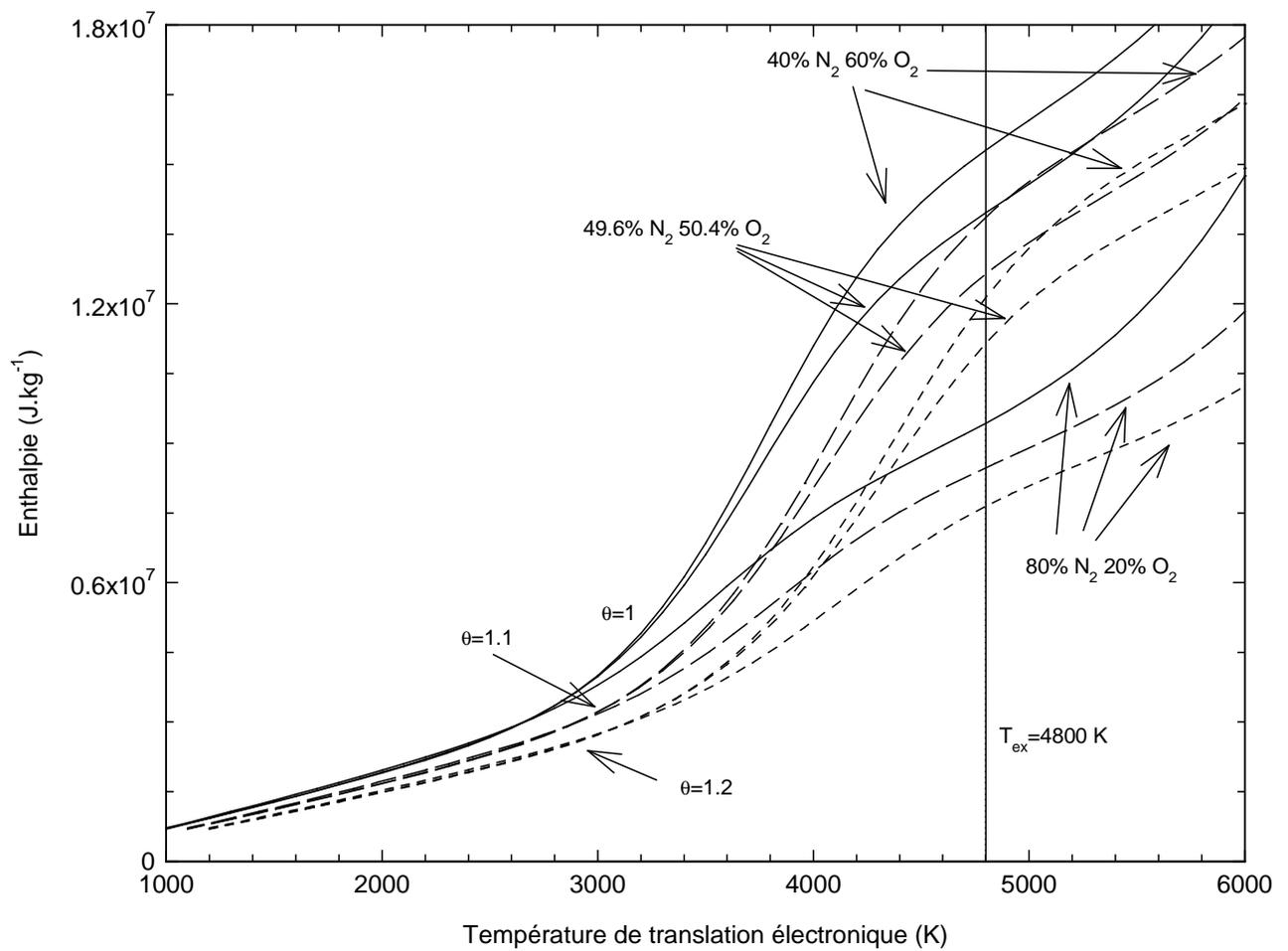
**Figure 4.13** : Comportement de l'enthalpie massique en fonction de la température de translation électronique (hypothèse 1) pour les différents mélanges de  $N_2$  et  $O_2$  en présence d'aérosol (0,4%) sous trois valeurs du degré de déséquilibre thermique.
