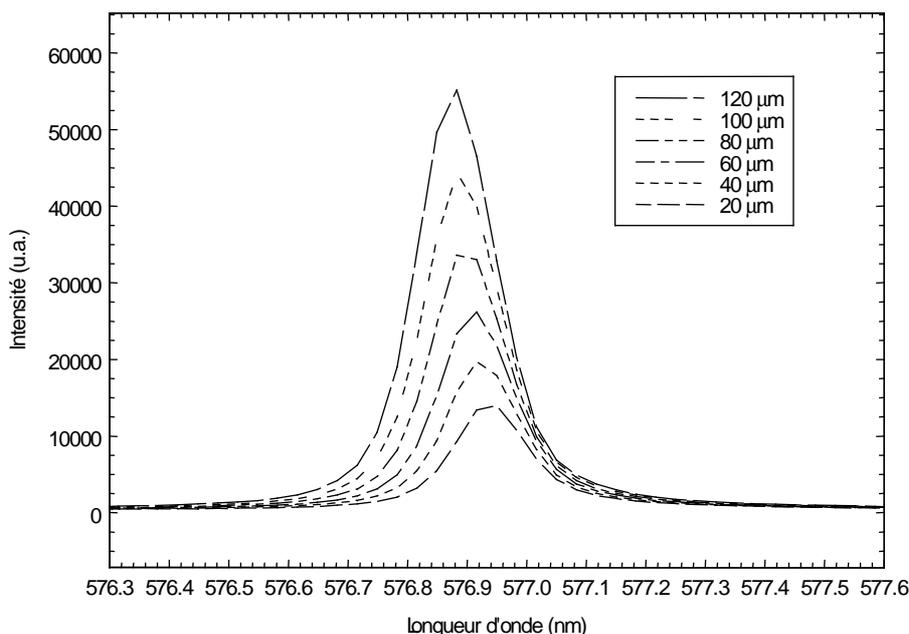
**Figure 3.8 :** Fonction d'appareil d'une raie mercure à  $576,96 \text{ nm}$  pour le réseau  $1200 \text{ traits/mm}$  selon l'ouverture de la fente d'entrée du spectromètre. Le temps d'acquisition des spectres est égal à  $2 \text{ s}$ .
