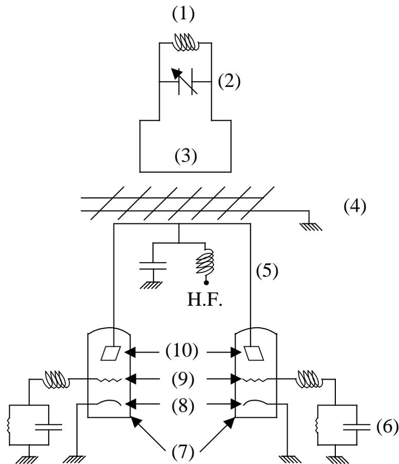
**Figure 3.1** : Schéma du générateur à lignes accordées. (1) inducteur ; (2) capacité de réglage de l'accord du circuit oscillant ; (3) lignes de couplage ; (4) grille arrêtant le champ électrique ; (5) lignes anodiques ; (6) circuit d'entretien des oscillations ; (7) triodes ; (8) plaques anodiques ; (9) grilles ; (10) cathodes.
