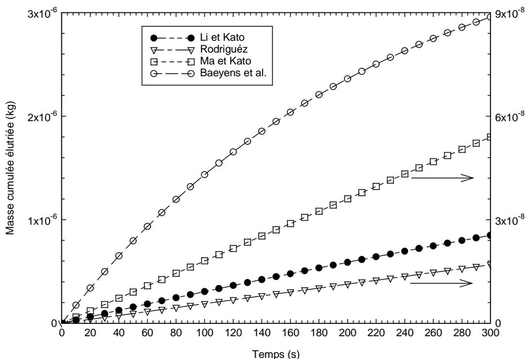
**Figure 5.22 :** Evolution de la masse cumulée éluée dans le cas du mélange 3 pour différentes corrélations pour la constante d'éluée  $K$ .
