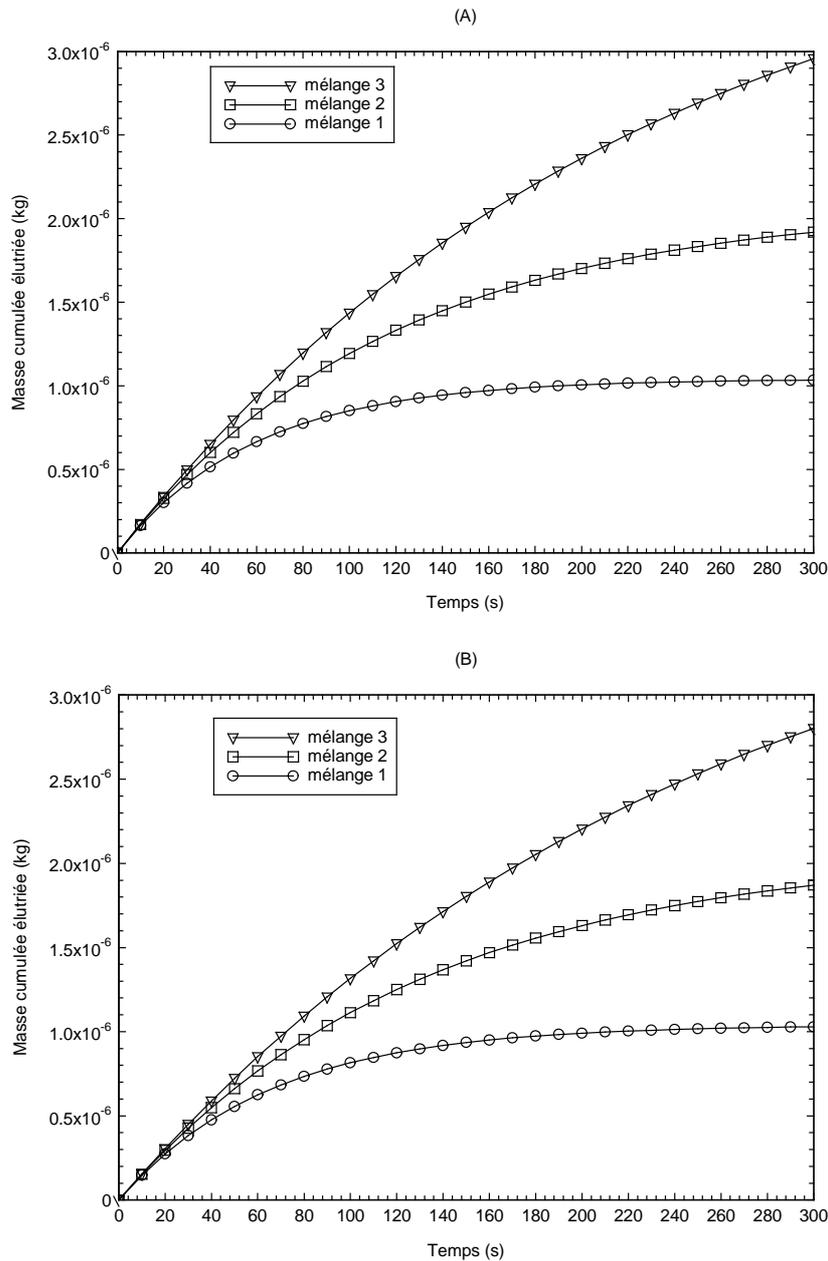
**Figure 5.20 :** Evolution de la masse cumulée éluée des particules d'oxyde de cuivre pour les trois mélanges (1, 2 et 3) en fonction du temps. (A) gaz fluidisant argon ; (B) gaz fluidisant air pur.
