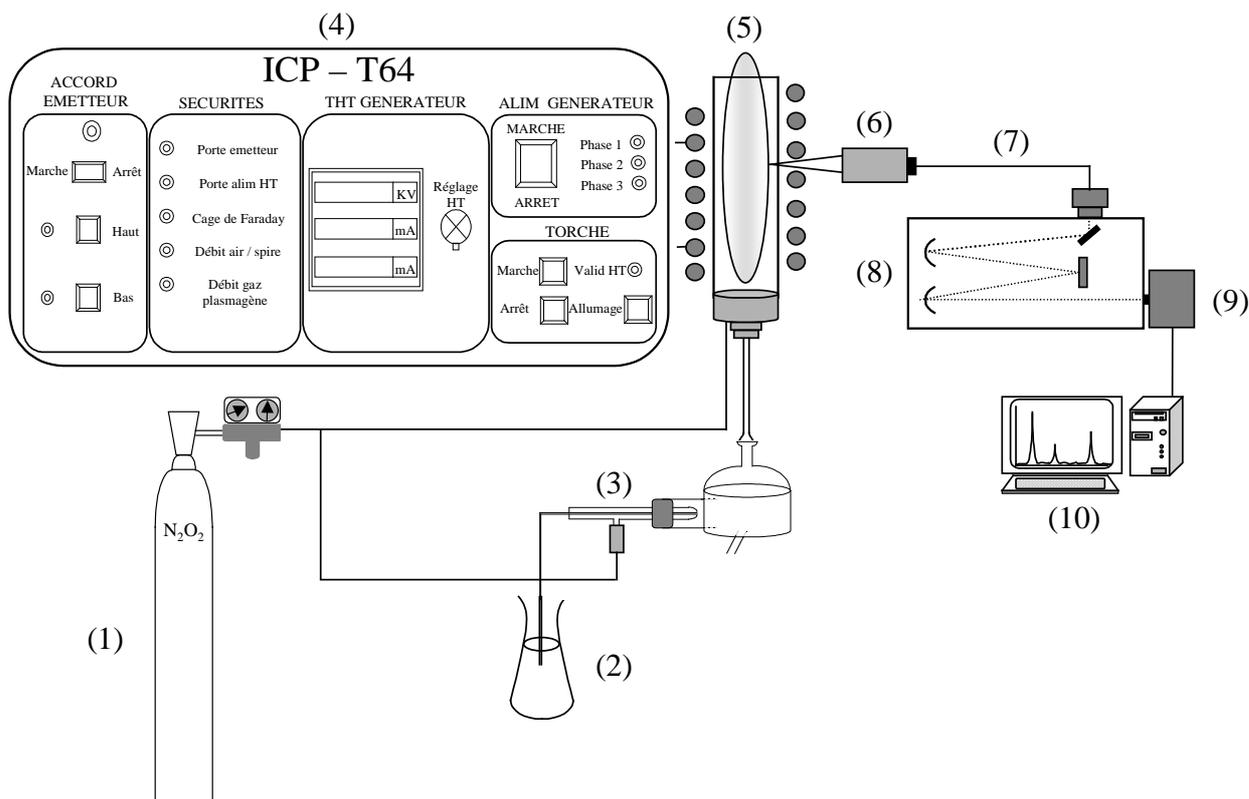
**Figure 4.1** : Schéma du dispositif expérimental pour le diagnostic des plasmas  $N_2-O_2$ . (1) bouteille de  $N_2-O_2$  (3 mélanges sont disponibles : 80%-20%, 49,6%-50,4%, 40%-60%) ; (2) solution aqueuse de sulfate de cuivre ( $CuSO_4, 5H_2O$ ) ; (3) nébuliseur Meinhard associé à une chambre cyclonique ; (4) générateur Haute-Fréquence ; (5) plasma ; (6) système optique ; (7) fibre optique ; (8) spectromètre ; (9) détecteur CCD ; (10) PC d'acquisition.
