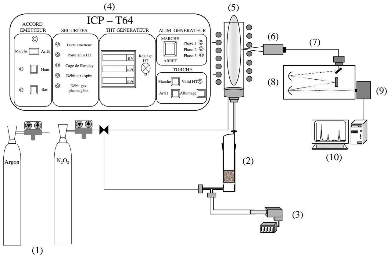
**Figure 5.1** : Schéma du dispositif expérimental pour l'étude du flux de particules. (1) gaz ; (2) réacteur de type lit fluidisé ; (3) capteur de pression ; (4) générateur Haute-Fréquence ; (5) plasma (air ou argon) ; (6) système optique ; (7) fibre optique ; (8) spectromètre ; (9) détecteur CCD ; (10) PC d'acquisition.
