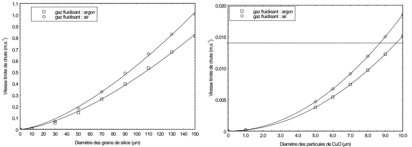
**Figure 5.4 :** Evolution de la vitesse limite de chute des différentes particules présentes dans le lit fluidisé en fonction de leurs diamètres.
