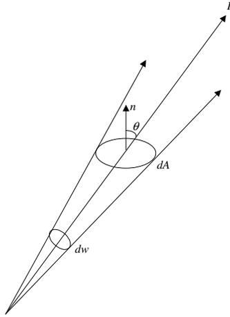
**Figure 1.1** : Définition de l'intensité spécifique ( $W.sr^{-1}.m^{-2}.nm^{-1}$ ).
