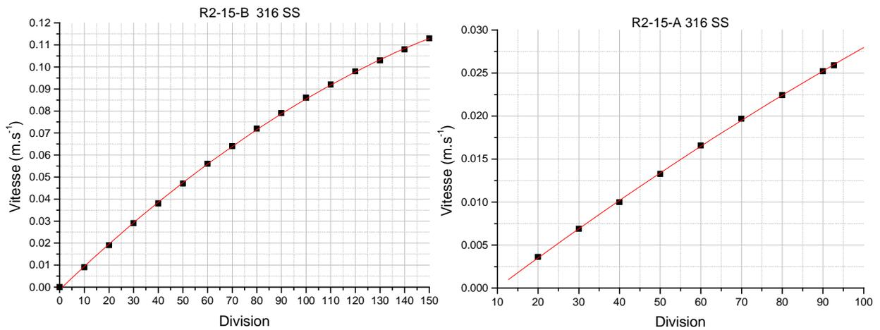
**Figure 5.3** Valeur de la vitesse du gaz fluidisant (air pur) dans le lit en fonction de la lecture sur les débitmètres volumiques.
