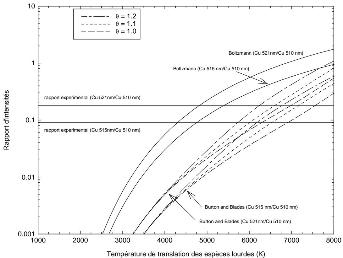
**Figure 4.10b** : Evolution des rapports d'intensités, selon la méthode de Boltzmann et la correction de Burton et Blades, en fonction de la température de translation des espèces lourdes (hypothèse 2) et du degré de déséquilibre thermique.
