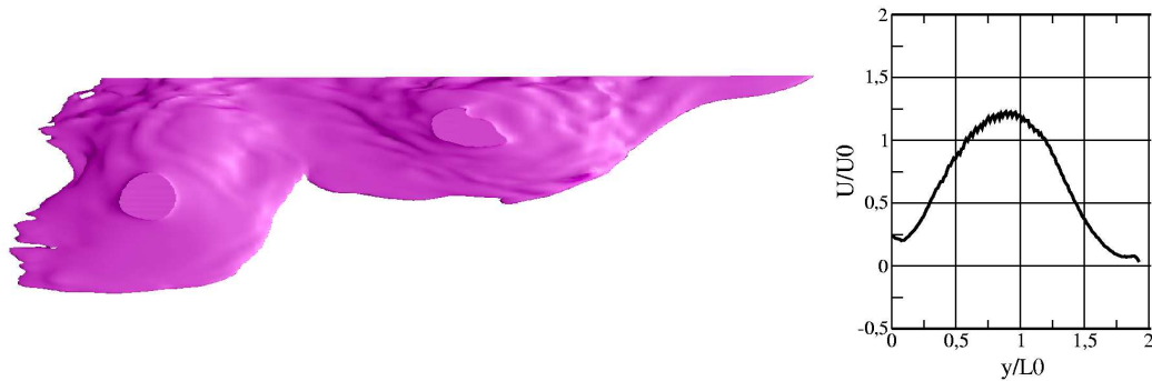
FIG. 2.10: Mod le HAROMOD : a) Surface de vorticit  verticale. Formation de deux tourbillons cycloniques qui sont advect s par le courant dense. b) Profil de vitesse normalis  (  comparer ult rieurement   la figure 3.20).
