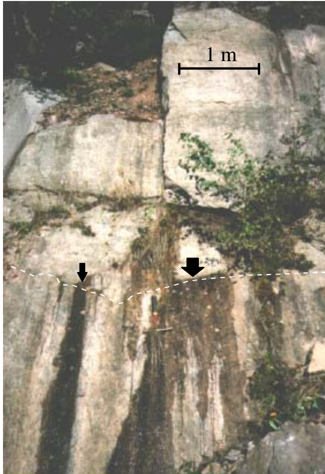
Figure 8: Mise en évidence de la chenalisation d'un écoulement fluide dans un plan de fracture macroscopique. (granite, carrière de Barbey Serroux, Vosges). Différentes fractures sont présentes. Certaines sont sèches. La fracture méridienne (trait pointillé) est percolée (écoulements = traces noires sur la roche représentées par des flèches) mais les fluides sortent de la roche par endroits seulement. Le plan de fracture présente donc des vides disponibles pour les fluides et des zones où soit la fracture est fermée (colmatage), soit son épaisseur est trop faible (les écoulements sont chenalisés aux endroits permettant les plus forts débits).
