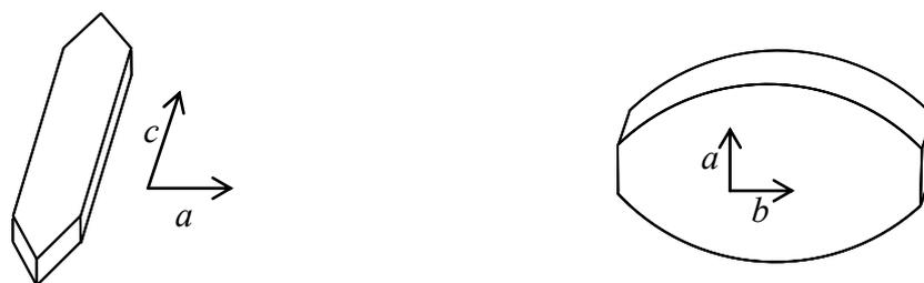
Figure III.13 : Représentation schématique d'un cristal de zéolithe de type MFI (à gauche) et de zéolithe de type MOR (à droite). Les directions des axes cristallographiques sont marquées par des flèches.
