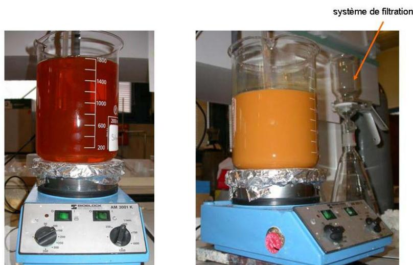
Figure 27 : photographie du montage expérimental utilisé pour réaliser la synthèse de l'akaganeite. a) solution initiale de chlorure ferrique, b) précipité orange d'akaganeite.
