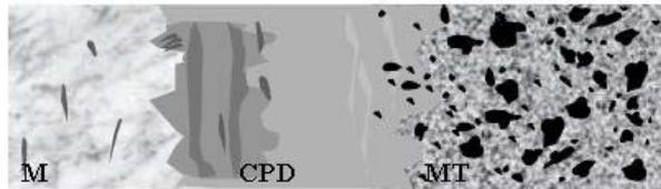
3b) taches d'hydroxychlorure ferreux  $\beta\text{-Fe}_2(\text{OH})_3\text{Cl}$  dans l'akaganeite  $\beta\text{-FeOOH}$
