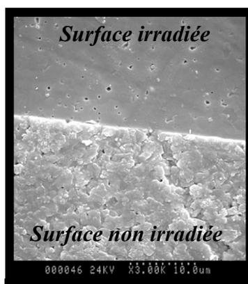
Figure 43. Observation par MEB de la surface d'une pastille frittée de  $\beta$ -PDTU à la frontière entre la zone non irradiée et la zone irradiée (Au 4 MeV,  $5 \cdot 10^{14} \text{ cm}^{-2}$ ).
