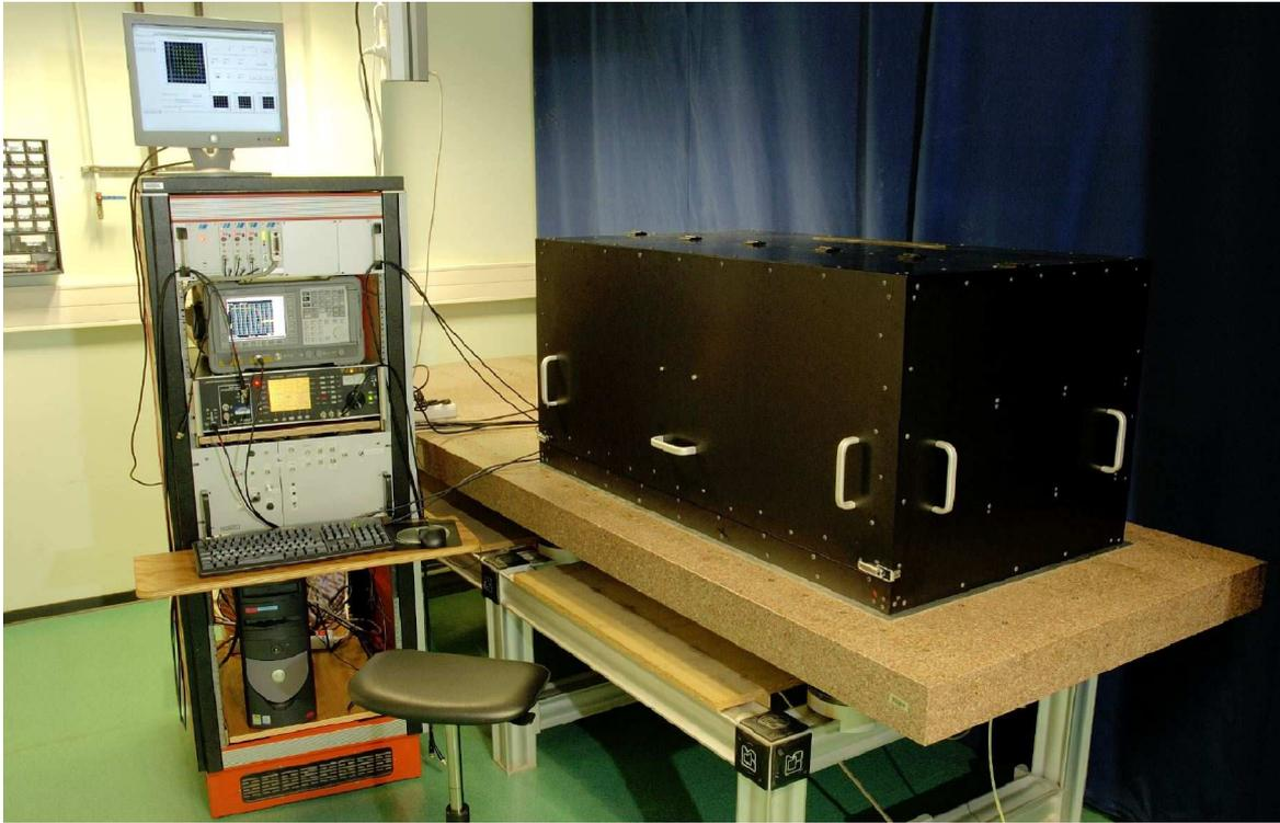
**FIG. 3.1:** Photographie générale du montage. L'électronique de traitement et de pilotage est regroupée dans la baie, à gauche, l'optique est dans la boîte noire. Seul un bloc de préamplification des signaux est adjoint à l'optique pour limiter les parasites.
