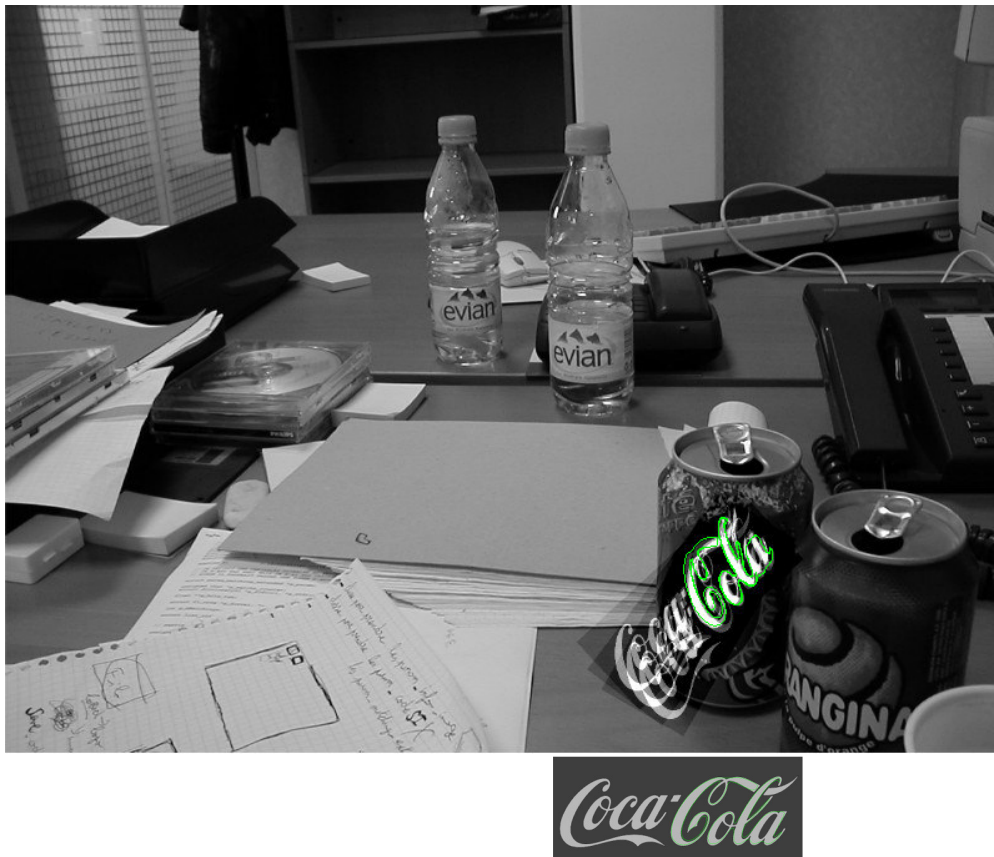
FIG. 4.4: Exemple de détection de logos (cont.) Le résultat de la mise en correspondance de tous les éléments de forme suivie d'un groupement par ressemblance de la transformation de similitude. Seul le logo de Coca-Cola donne un cluster de transformations significatif.
