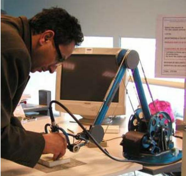
(a) Système de co-manipulation *Surgicobot*.
