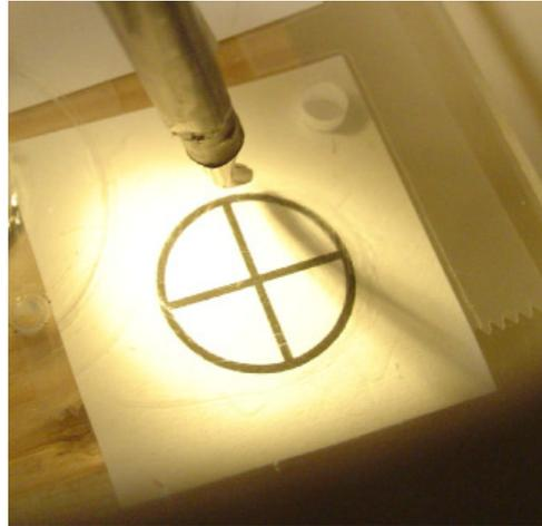
FIG. 4.9 – Pointe de l'instrument en contact avec un cercle tracé sur la surface d'une plaque en plexiglas.
