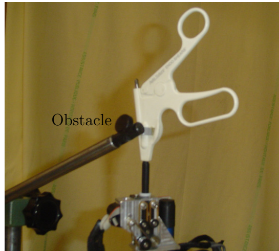
FIG. 4.13 – Obstacle placé au niveau de la poignée de l'instrument.
