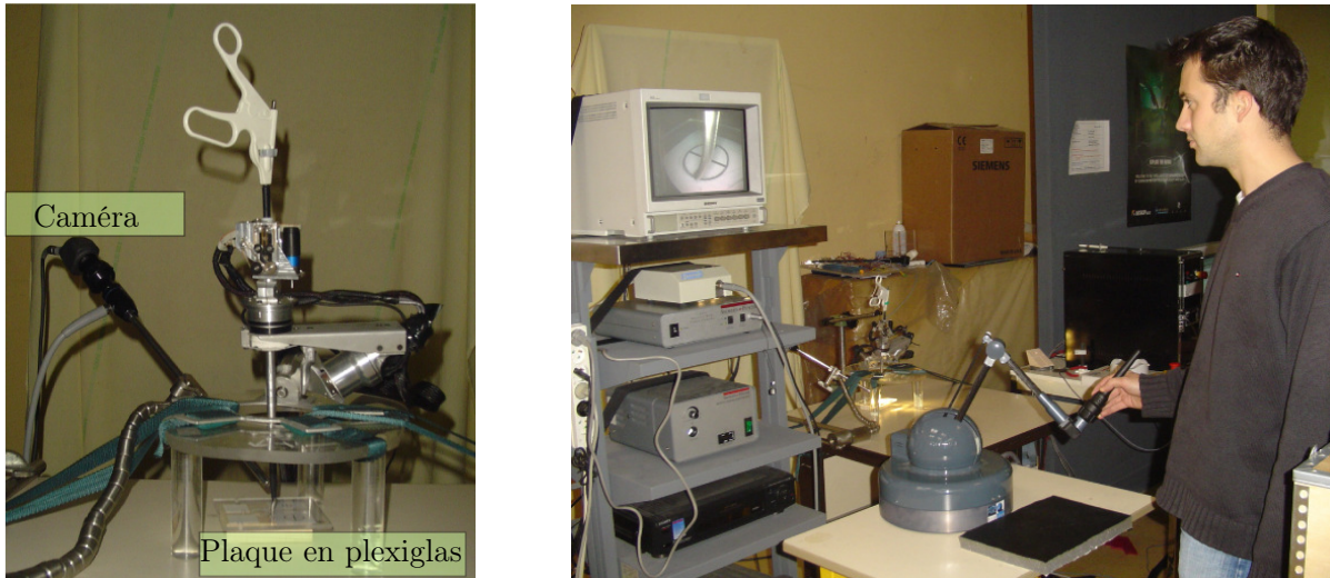
(a) Robot esclave MC^2E commandé en mode position/force.
