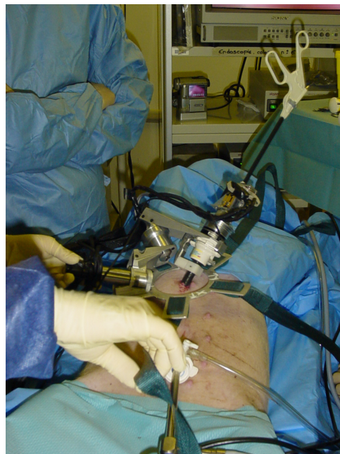
(c) Étape 3, 4 et 5 : Attacher le robot au trocart, centrer la base du robot et l'attacher à la table d'opération.
