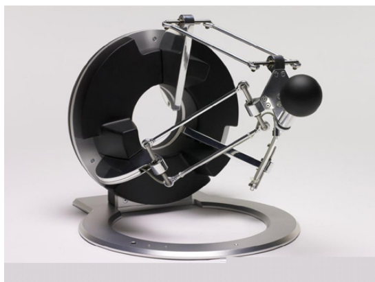
(a) Interface haptique OMEGA à 3 ddl en effort.
