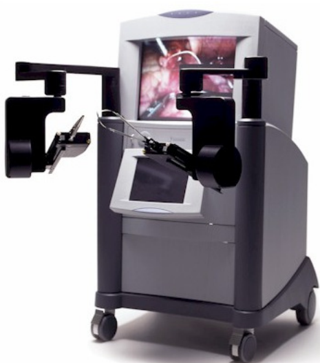
(a) Manipulateur maître du robot Zeus
