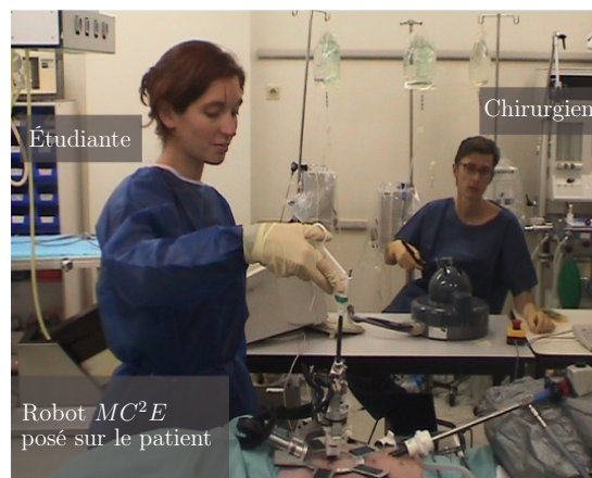
FIG. 4.18 – Co-manipulation en télé-chirurgie laparoscopique à retour d'effort avec le robot MC^2E .
