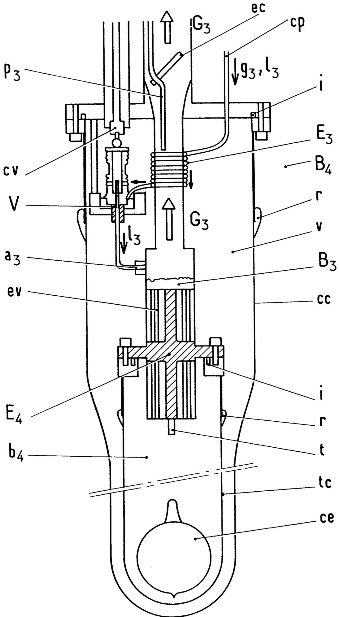
tion de liquide à la partie froide, ce qui permet un fonctionnement continu. Il est représenté sur la figure I-3. De la partie inférieure ont été éliminés, autant que possible, tous les constituants magnétiques.
