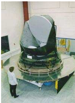
FIG. II.13: Le télescope de PLANCK comprend deux miroirs elliptiques de 1.5 x 1.9 mètres pour le primaire et 1 x 1.1 mètres pour le secondaire. A gauche, photo du modèle de qualification de PLANCK, dans les locaux de Space Alcatel à Cannes. Elle donne une idée des dimensions du télescope, que l'on aperçoit protégé par ses écrans thermiques. A droite, schéma de la configuration du télescope. Le choix d'un large miroir primaire permet de limiter la redirection vers le détecteur, de la lumière parasite – celle d'angle d'incidence ne coïncidant pas avec la direction de l'axe optique.
