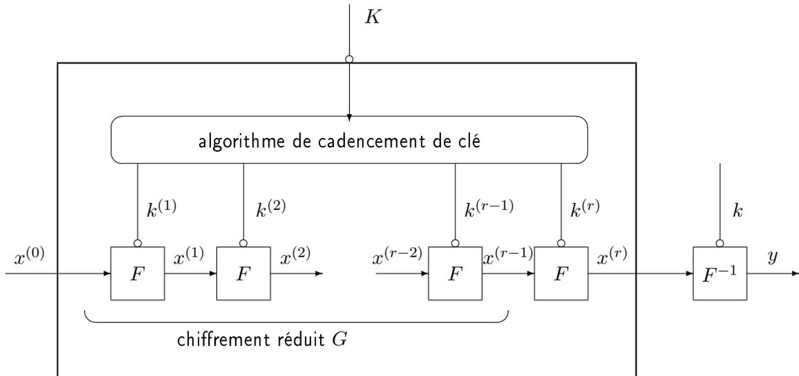
FIG. 2.1 – Principe d'une attaque sur le dernier tour
