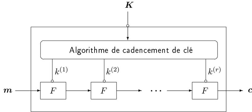
FIG. 1.11 – Principe d'un chiffrement itératif par blocs
