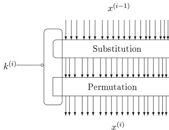
FIG. 1.14 – Une itération dans un réseau de substitution-permutation
