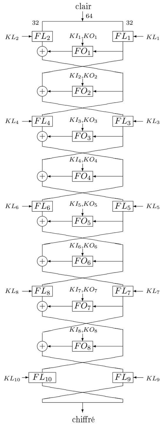
FIG. 3.1 – Le système de chiffrement MISTY1
