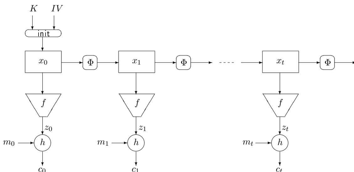
FIG. 1.3 – Principe général d'un chiffrement à flot synchrone
