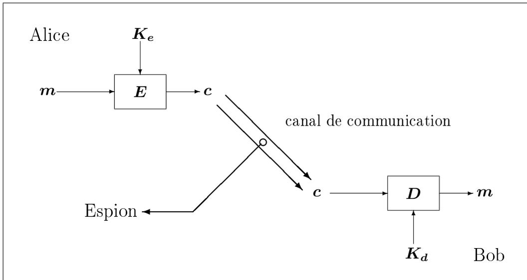
FIG. 1 – Principe du chiffrement et du déchiffrement
