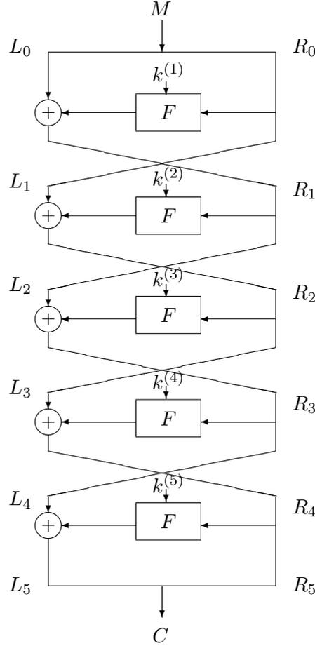
FIG. 4.1 – Cinq tours d'un chiffrement de Feistel
