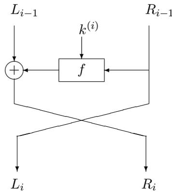
FIG. 1.12 – Fonction itérée d'un chiffrement de Feistel
