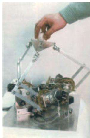
FIG. 1.2 – Le *HapticMaster*, structure parallèle à 3 ddl actifs
