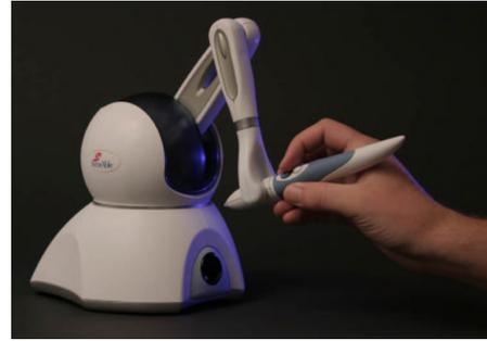
FIG. 1.4 – Le *PHAMToM-Omni*. Structure mécanique série
