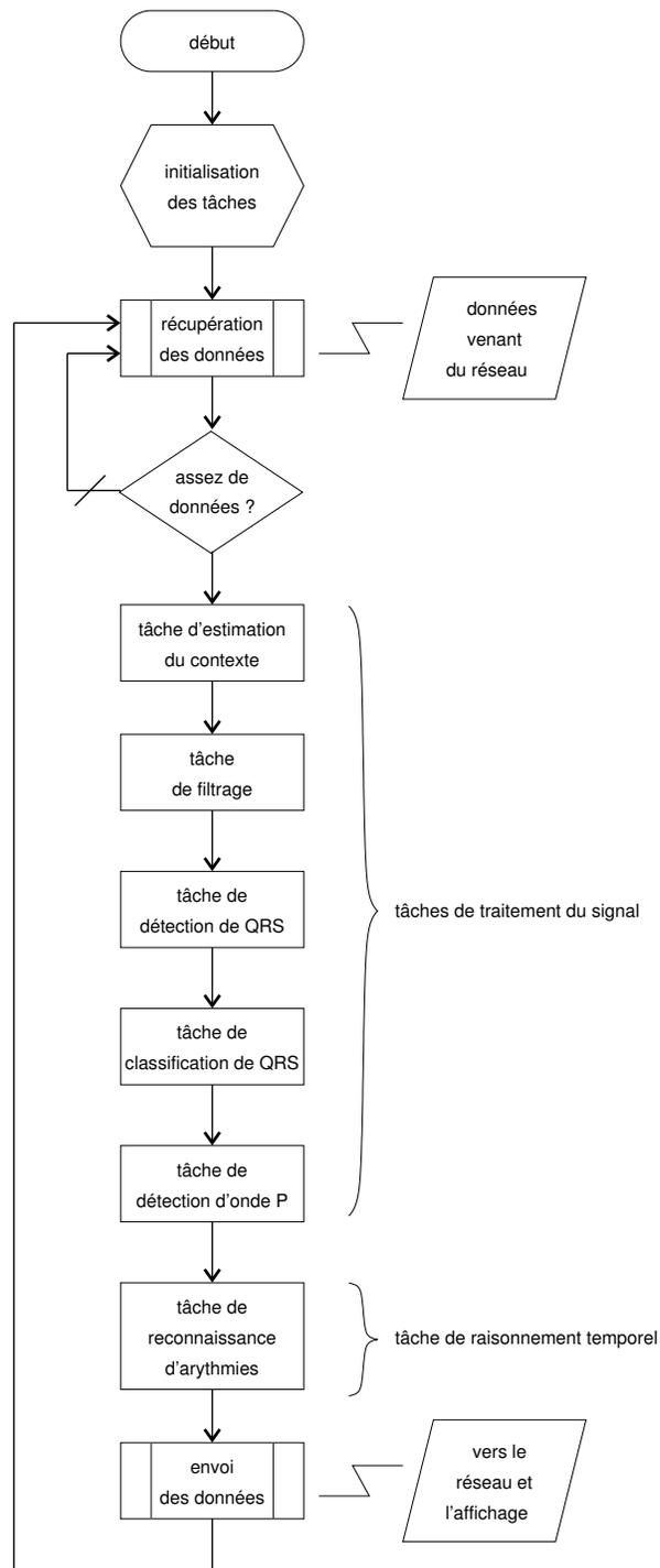
FIG. 6.10 – Diagramme de l'application de monitoring cardiaque.
