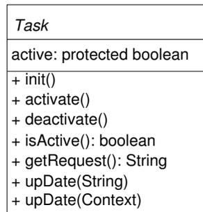
FIG. 6.4 – Diagramme UML de la classe **Task**.
