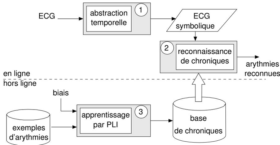
FIG. 2.10 – Architecture générale du système de monitoring CALICOT.
