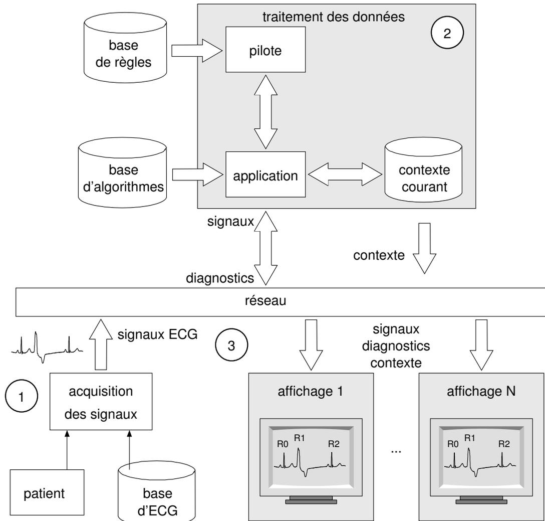
FIG. 3.1 – Architecture globale du système piloté.
