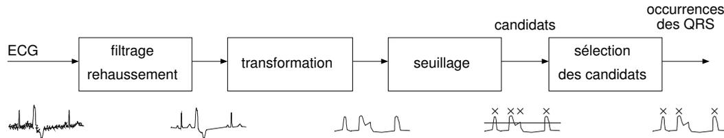
FIG. 4.2 – Schéma bloc d'un détecteur de QRS.
