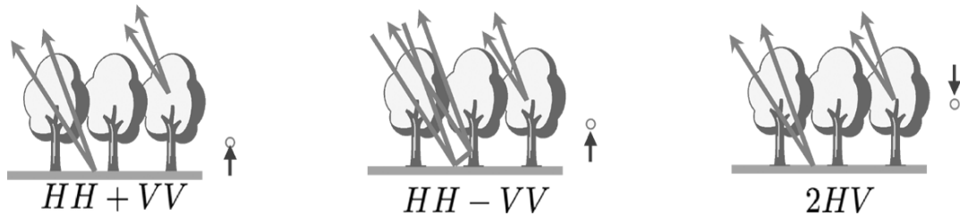
FIG. 3.2 – Décalage des centres de phase - cas réel
