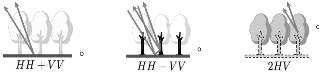
FIG. 3.1 – Distinction des centres de phase en fonction de la polarisation - cas idéal
