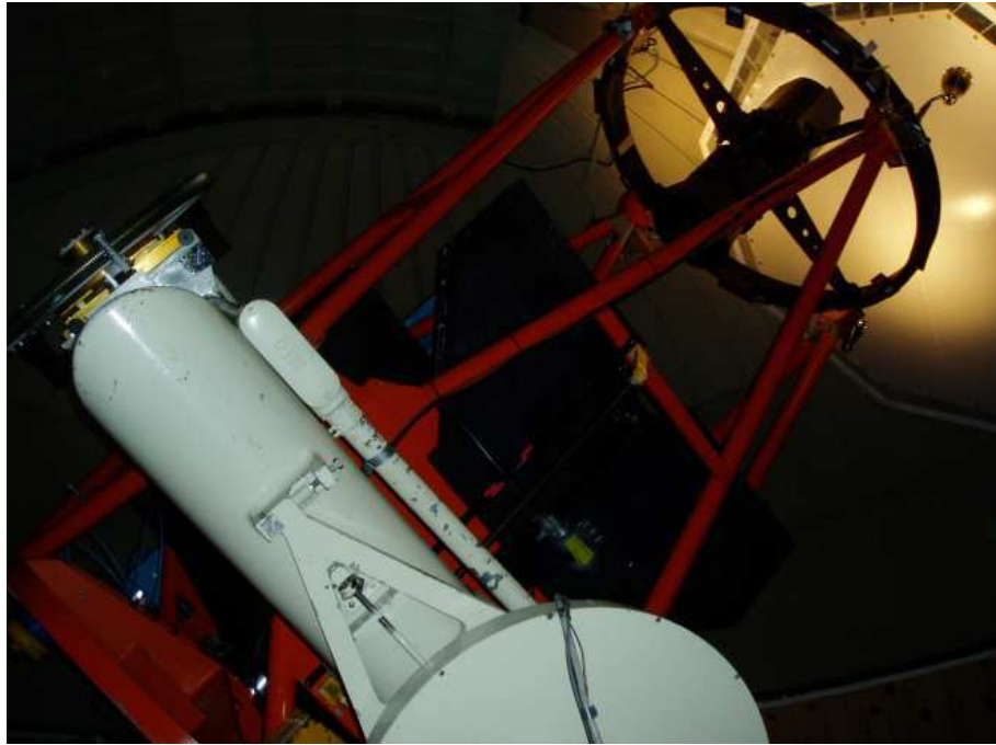
FIG. 8.5 – Le télescope de 1.5 m de San Pedro Martir, lors de la campagne 2005. En haut à droite de l'image, les quatre lampes de bureau, fixées à l'armature du télescope, éclairent l'écran blanc destiné aux champs plats. L'outil utilisé afin d'arrimer les lampes est le scotch.
