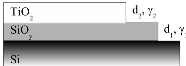
FIG. 4.11 – Structure modèle du système TiO<sub>2</sub>/SiO<sub>y</sub>/Si utilisée dans la détermination des épaisseurs  $d_i$  et des taux de recouvrement  $\gamma_i$ .
