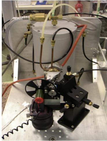
(a) Au premier plan, le modulateur (*chopper*) et le dispositif d'injection du flux dans la fibre optique. Au second plan, le corps noir et son système de refroidissement par eau.
