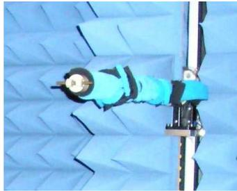
FIG. 6.8: **Sonde** : elle est constituée d'un dipôle.
