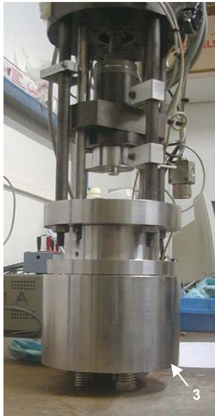
Figure 7.3.bis : Vue de détail de la cellule « microperméabilité » avec la cellule de confinement (3).
