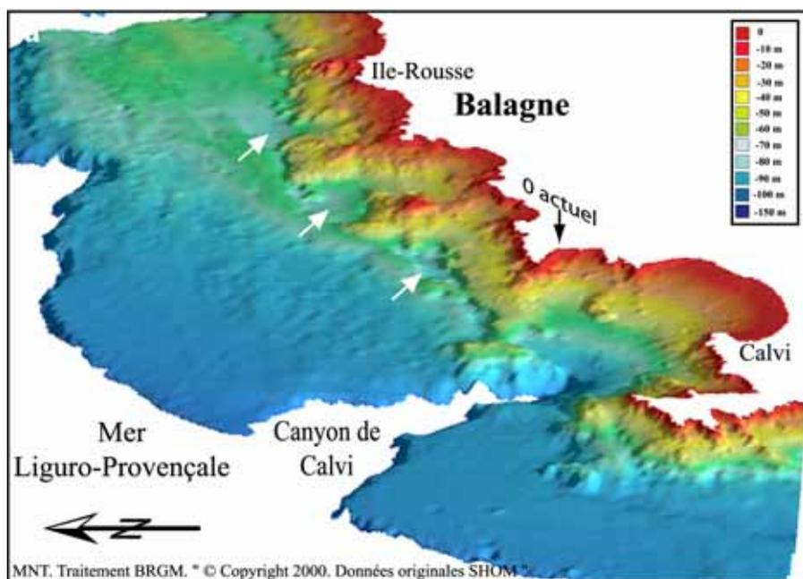
**Figure 3.22** – Vue 3D (vers l'Est) montrant la morphologie sous-marine de la plate-forme de la Balagne établie à partir d'un modèle numérique de terrain (traitement Vertical Mapper<sup>TM</sup>). Les flèches blanches indiquent la position des principales dépressions fermées.
