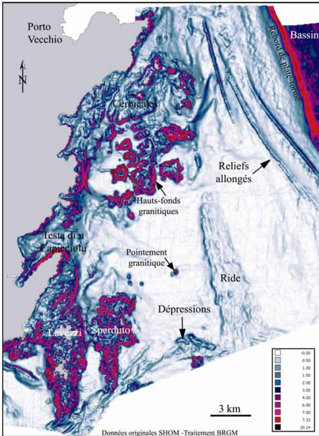
**Figure 3.39** – Carte des pentes calculées à partir du modèle numérique de terrain de la plate-forme orientale des Bouches de Bonifacio (traitement Vertical Mapper<sup>TM</sup>).
