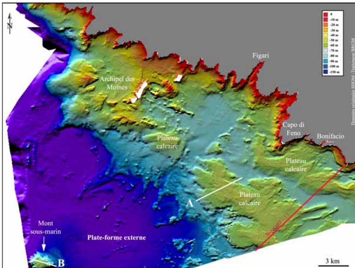
**Figure 3.32** – Morphologie de la plate-forme occidentale des Bouches de Bonifacio mise en évidence par ombrage du modèle numérique de terrain au pas de 50m. Les traits blancs correspondent aux profils bathymétriques des figures 3.33 (A) et 3.35 (B). La localisation du profil de sismique réflexion Bocca99 - 17 a également été reportée.
