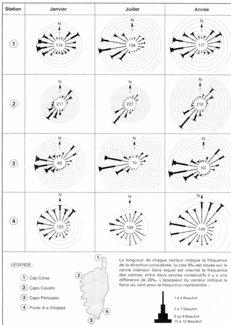
**Figure 1.6** – Roses de fréquences moyennes des directions du vent (hiver, été, et moyenne annuelle) pour quatre stations réparties sur les côtes de la Corse. La moyenne est réalisée sur une période d’observation de 25 ans. Source : Météo-France. (In SHOM, 1997).
