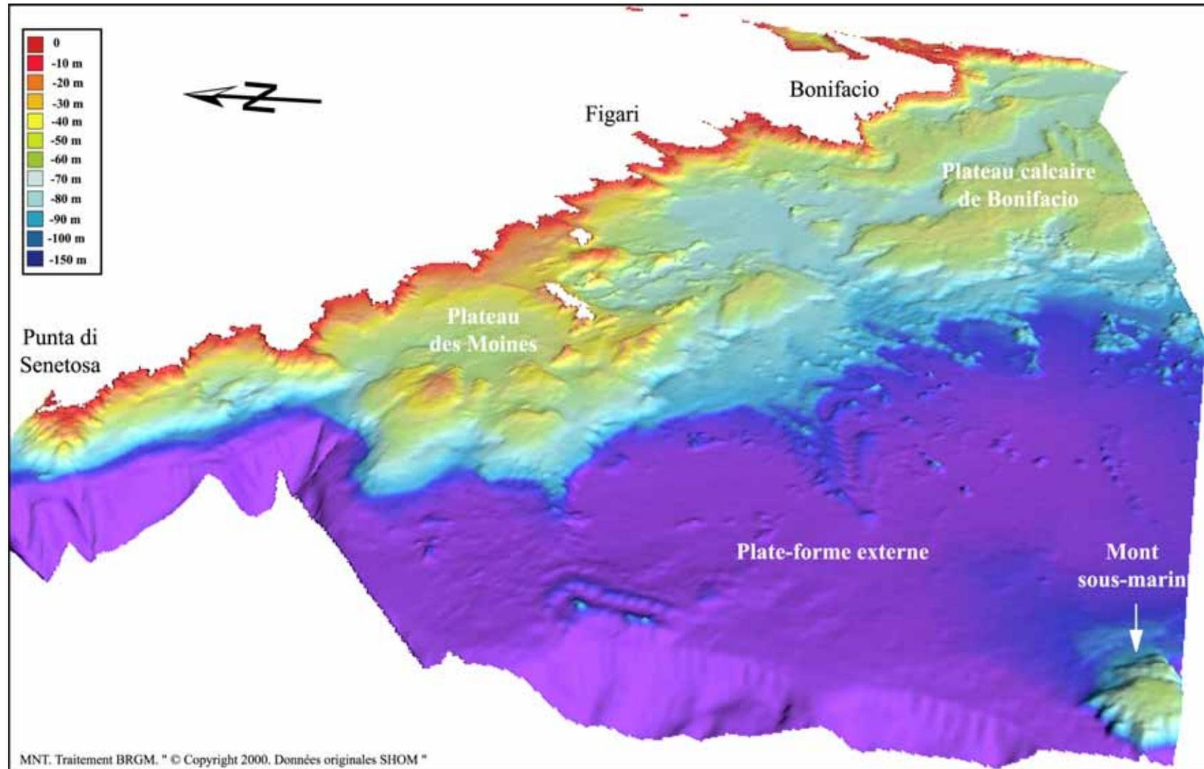
**Figure 3.34** – Vue 3D (depuis l’Ouest, en regardant en direction de l’Est) montrant la morphologie sous-marine de la plate-forme occidentale des Bouches de Bonifacio, établie à partir d’un modèle numérique de terrain (traitement Vertical Mapper<sup>TM</sup>). L’échelle des hauteurs est respectée.
