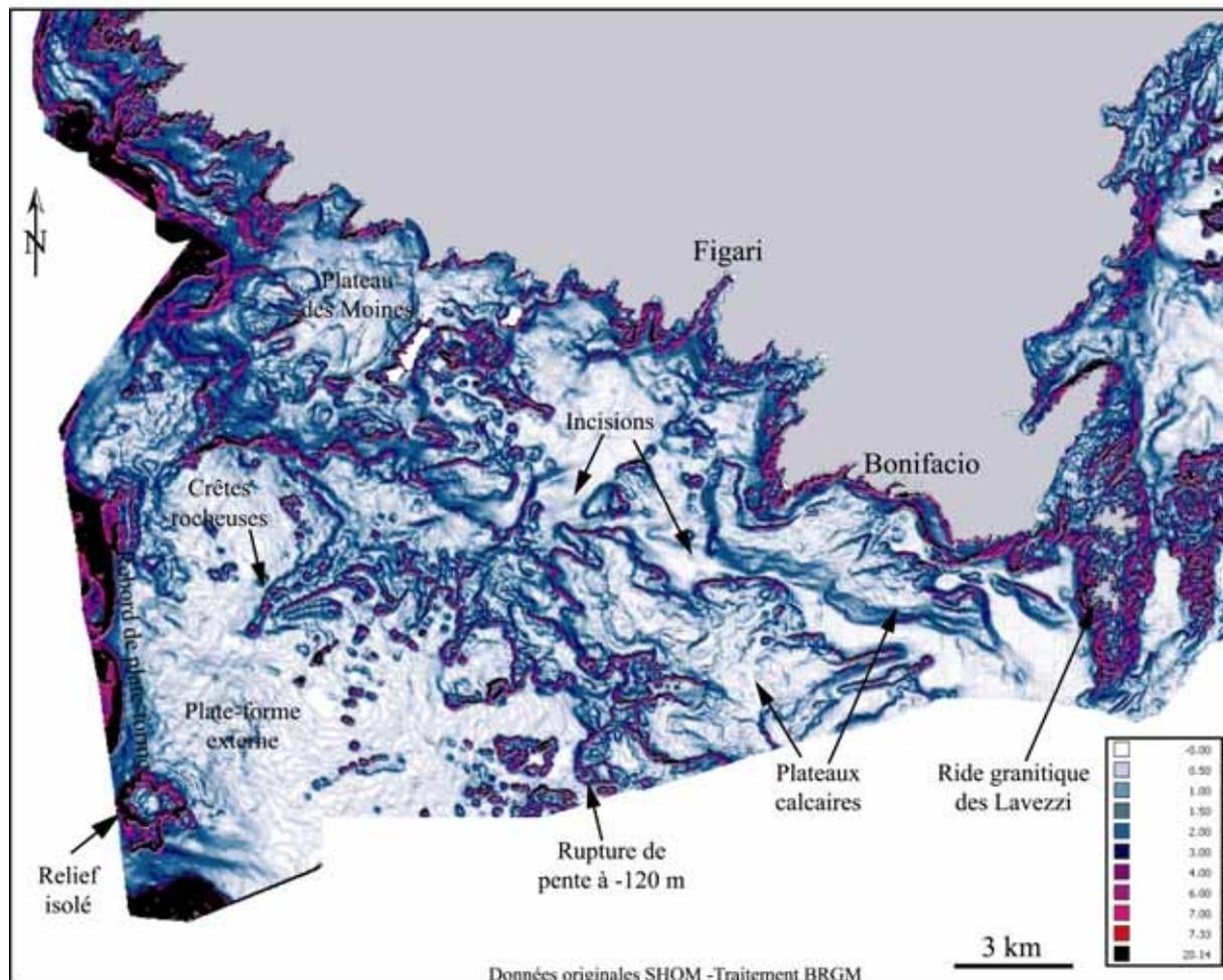
**Figure 3.31** – Carte des pentes calculée à partir du modèle numérique de terrain de la plate-forme occidentale des Bouches de Bonifacio (traitement Vertical Mapper™).
