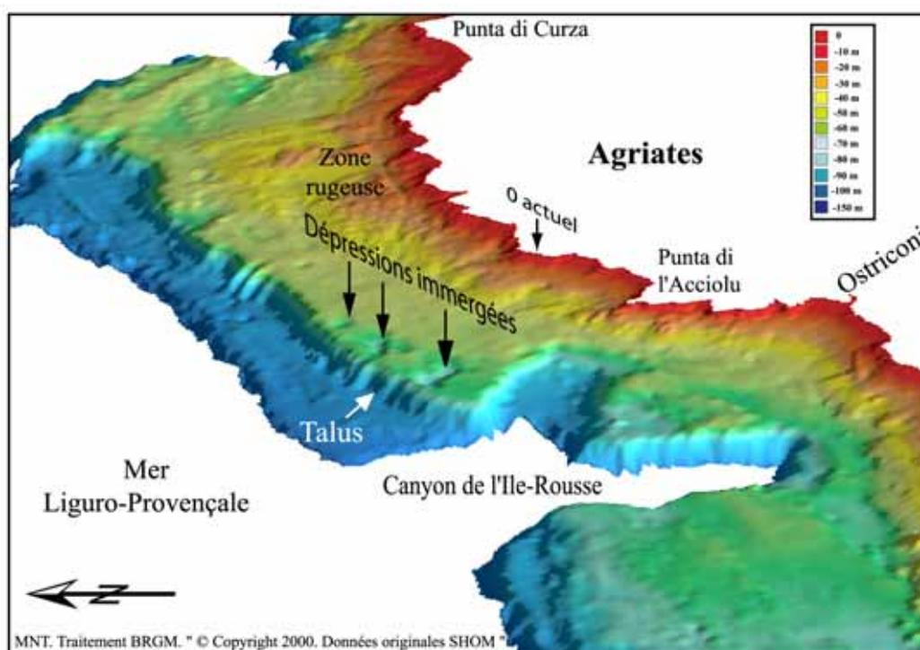
**Figure 3.25** – Vue 3D (vers l'Est) montrant la morphologie sous-marine de la plate-forme des Agriates établie à partir d'un modèle numérique de terrain (traitement Vertical Mapper<sup>TM</sup>).
