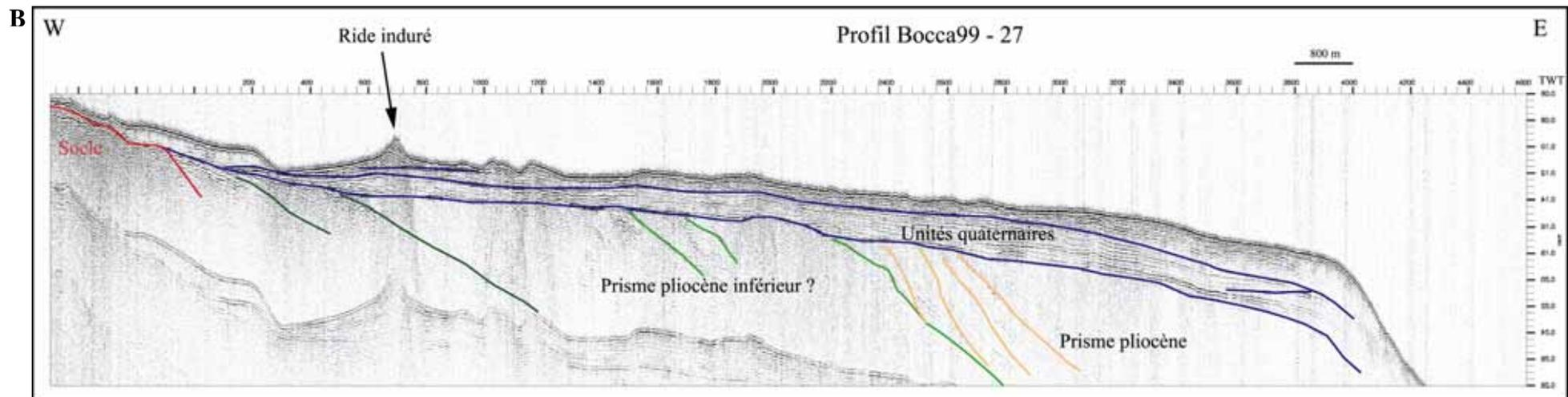
**Planche 3.5** – Profils de sismique-réflexion sur les plates-formes des Bouches de Bonifacio. A : Profil sismique montrant la structure générale de la plate-forme occidentale des Bouches de Bonifacio au niveau des plateaux calcaires (la localisation du profil est reportée sur la Fig. 3.32). B : Profil sismique montrant la structure générale de la plate-forme orientale et les reliefs indurés (la localisation du profil est reportée sur la Fig. 3.37).
