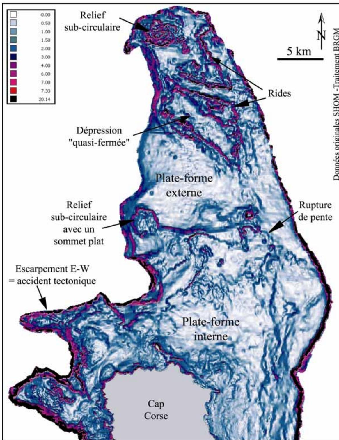
**Figure 3.15** – Carte des pentes calculée à partir du modèle numérique de terrain de la plate-forme nord du Cap Corse (traitement Vertical Mapper<sup>TM</sup>).
