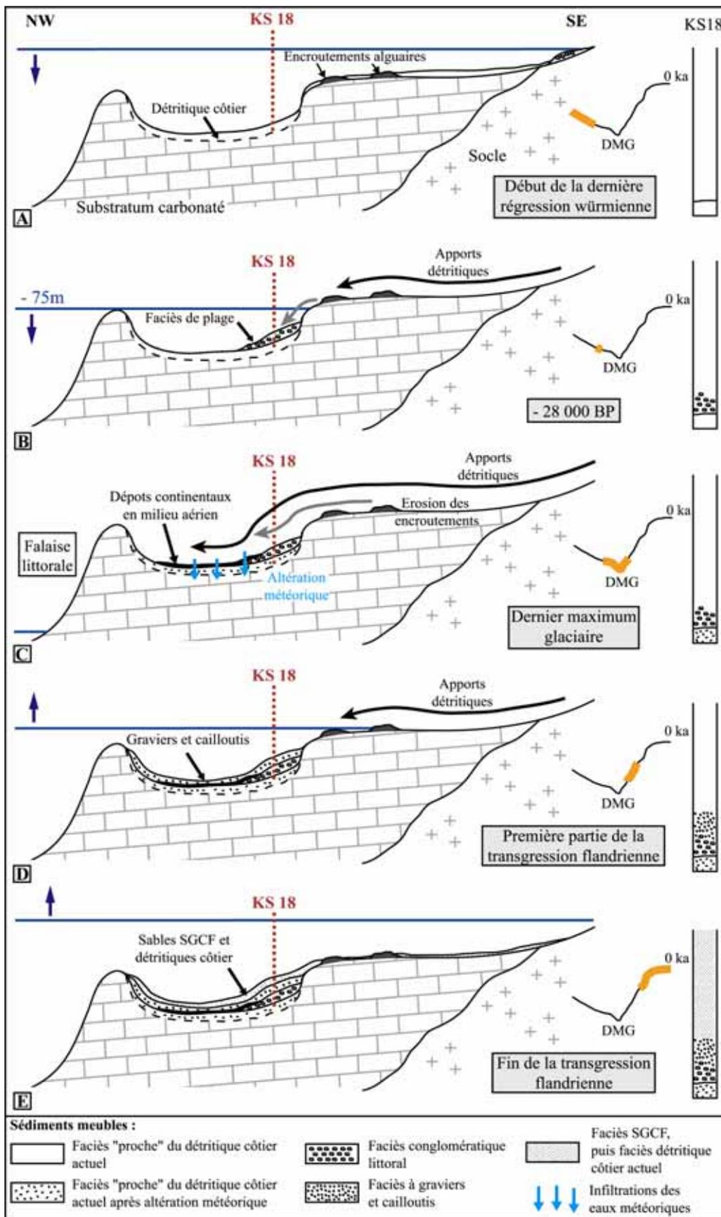
**Figure 7.6** – Reconstitution chronologique de la séquence des dépôts sur la plate-forme à l’Ouest des Agriates depuis le début de la dernière régression würmienne (l’échelle des distances horizontales n’est pas respectée). Chaque étape est replacée sur la courbe de modélisation des variations eustatiques en Méditerranée depuis 35 000 ans (Lambeck & Bard 2000). DMG = dernier maximum glaciaire.
