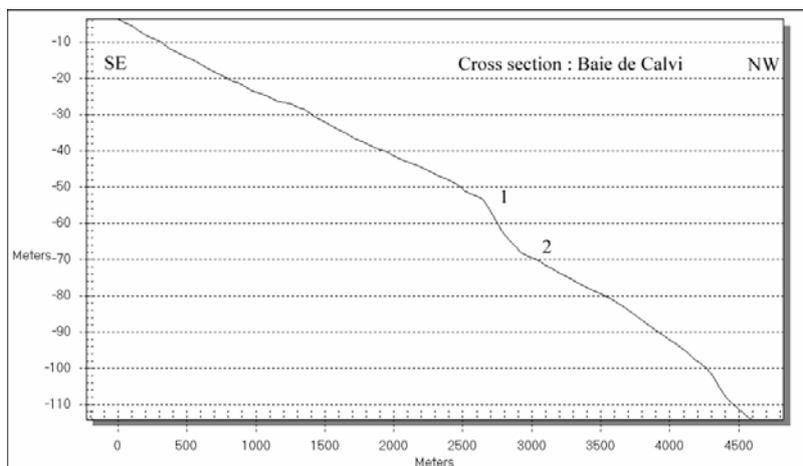
**Figure 3.21** – Profil bathymétrique réalisé le long de la pente dans l'axe de la baie de Calvi. La position du profil est indiquée sur la figure 3.20. 1 : rupture de pente à environ -55m et 2 : rupture de pente à -70m.
