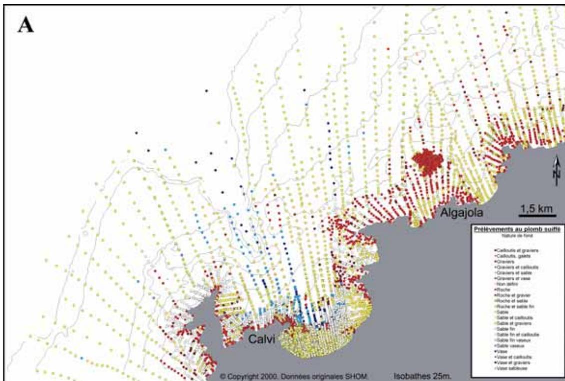
**Figure 2.5 a** – Visualisation sous SIG de la distribution des levés anciens au plomb suiffé (1884 à 1891) sur la partie sud de la plate-forme de la Balagne : faciès principaux de nature de fond (avec les roches en rouge, les sables en jaune et les vases et vases sableuses en bleu). Notez la plus forte densité de prélèvements à proximité des côtes.
