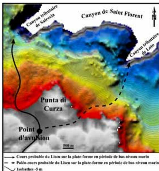
Figure 5.34 – Mises en évidence de part et d'autre de la Punta di Curza de deux incisions formées en période de bas niveau marin sur la plate-forme des Agriates, à partir d'un modèle numérique de terrain au pas de 10m.
