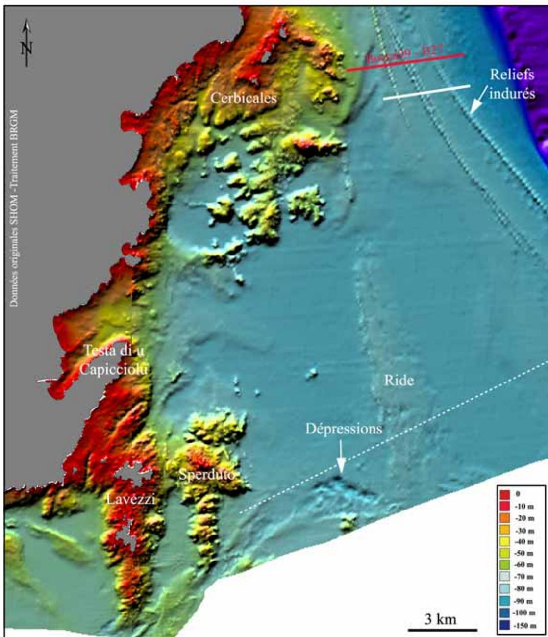
**Figure 3.37** – Morphologie de la plate-forme orientale des Bouches de Bonifacio mise en évidence par ombrage du modèle numérique de terrain au pas de 50m. Le trait blanc correspond au profil bathymétrique de la figure 3.40. Le trait pointillé correspond au profil sismique de la figure 3.36.
