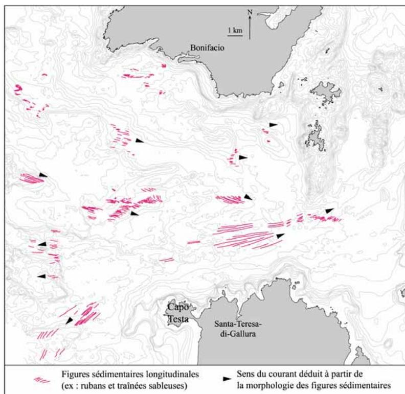
**Figure 6.5** – Cartographie des figures sédimentaires longitudinales (rubans et traînées de sable) et des sens de courant déduits à partir de la morphologie des marques d’obstacles sur la plate-forme occidentale des Bouches de Bonifacio.
