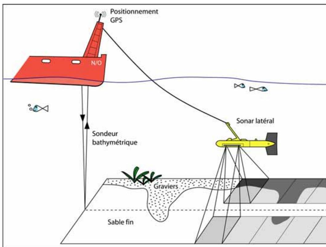
**Figure 2.9** – Principe de mise en œuvre du sonar à balayage latéral.
