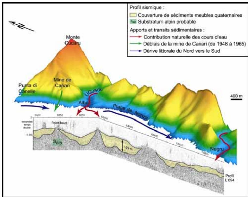
**Figure 5.35** – Représentation 3D montrant les corrélations entre la couverture de sédiments meubles quaternaires observée par sismique-réflexion au Sud de la mine de Canari et les apports et transits sédimentaires au niveau du littoral. La localisation du profil L094 est reportée Pl.5.1.
