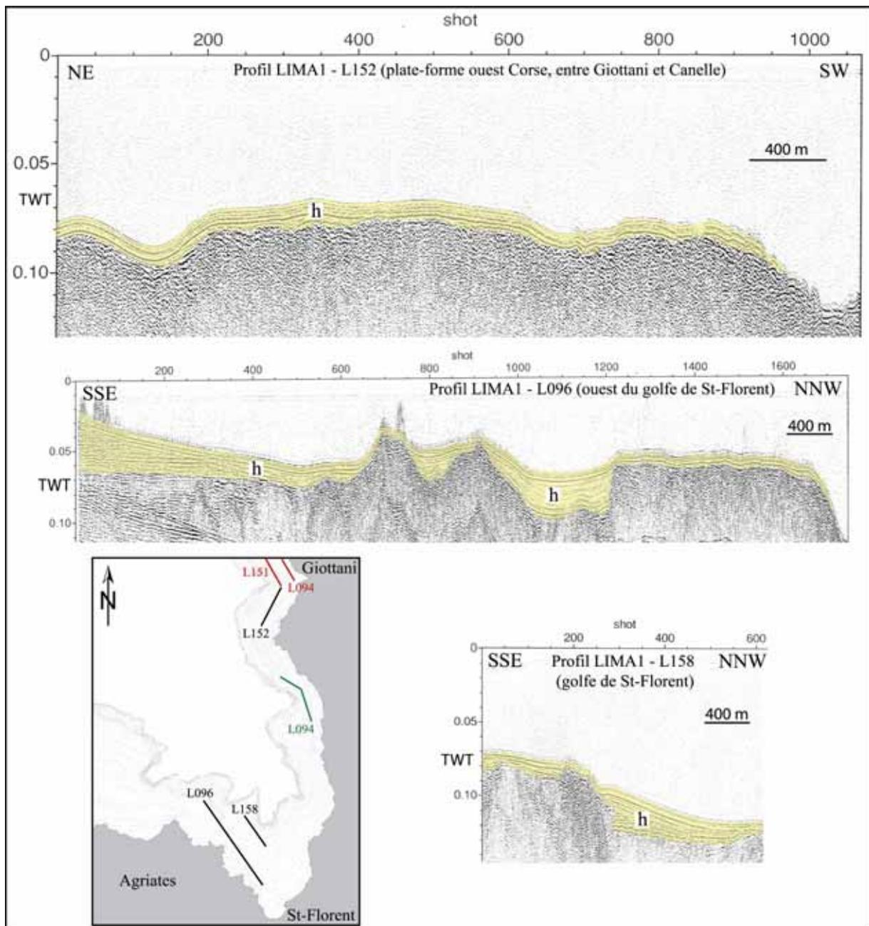
**Planche 5.1** – Exemples de dépouillement de profils de sismique-réflexion, avec mise en évidence de la couverture de sédiments meubles quaternaires (h) sur les plates-formes du golfe de Saint-Florent et de l’Ouest du Cap Corse. Le plan de localisation indique aussi la position du profil L094 de la figure 5.35 (en vert) et des profils L151 et L094 de la figure 5.37 (en rouge).
