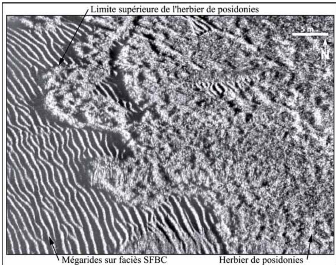
**Figure 5.13** – Sonogramme montrant des mégarides de houle sur un fond de sables fins bien qualibrés, à la limite supérieure de l'herbier à *Posidonia oceanica*. Image sonar latéral à haute résolution.
