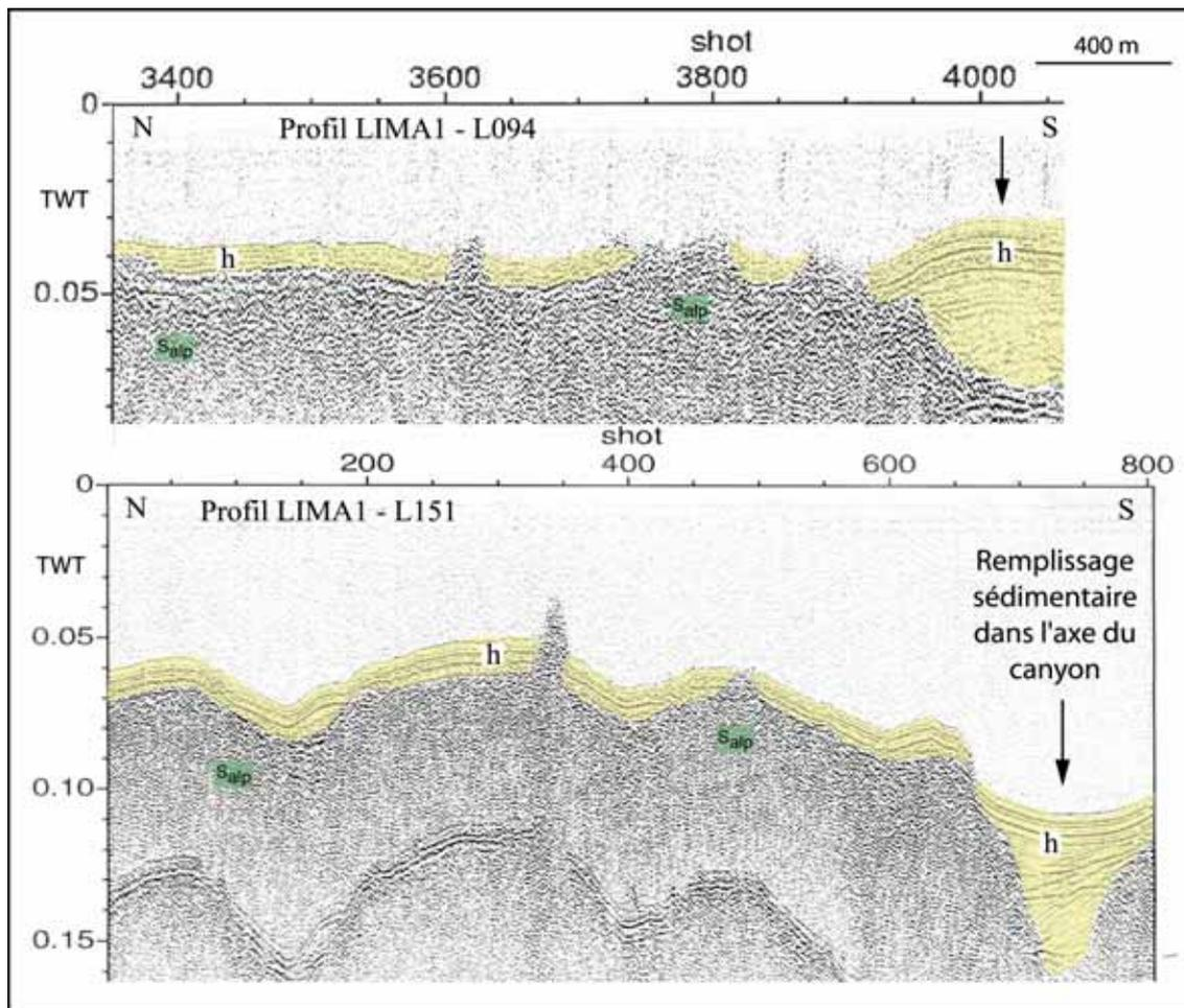
**Figure 5.37** – Extraits de profils de sismique-réflexion montrant une profonde incision (flèche) du substratum alpin (Salp) dans l'axe de la tête du canyon de Giottani, et son remplissage sédimentaire (h) par les apports du ruisseau de Piaggia. La localisation des profils L094 et L151 est reportée Pl.6.1.
