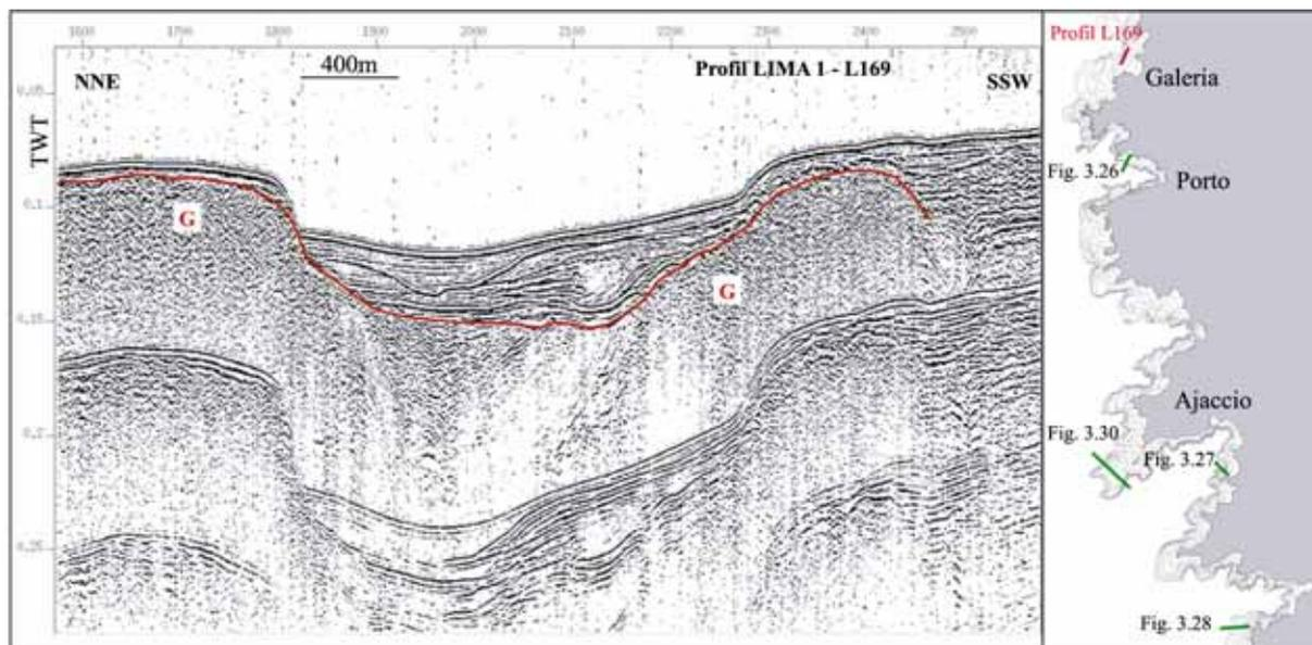
**Figure 3.29** – Extrait de profil sismique montrant les remplissages sédimentaires successifs dans l’axe de la tête du canyon de Galéria, et le socle hercynien (G) recouvert d’une mince couverture sédimentaire sur les flancs. Profil mission LIMA1 – L169.
