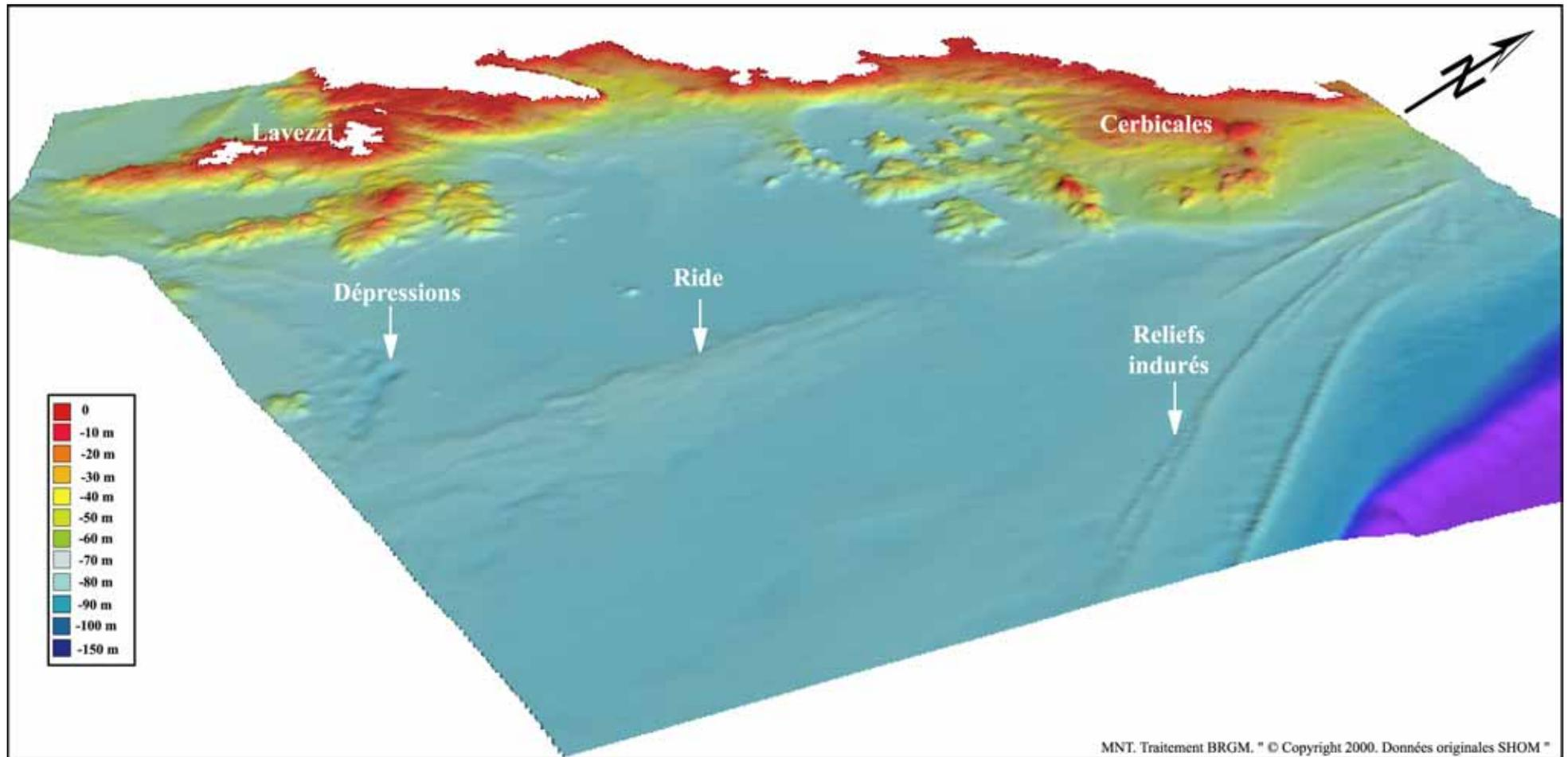
**Figure 3.38** – Vue 3D (depuis l’Est, en regardant en direction de l’Ouest) montrant la morphologie sous-marine de la plate-forme orientale des Bouches de Bonifacio, établie à partir d’un modèle numérique de terrain (traitement Vertical Mapper<sup>TM</sup>). L’échelle des hauteurs est respectée.
