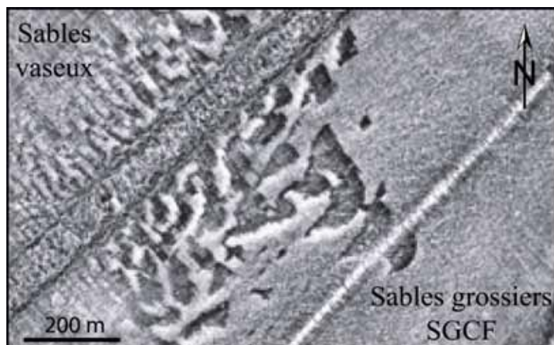
Figure 5.21 – Sonogramme montrant les « loupes » d'arrachement semi-circulaires au niveau de la limite complexe entre les sables vaseux et les sables grossiers du faciès SGCF en baie de Calvi.
