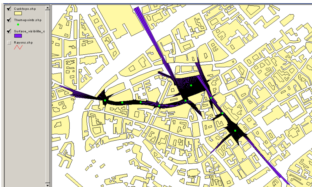
Figure 187 : Visualisation des surfaces de visibilité : vue générale de Strasbourg 360 lancers effectués chaque point de calcul
