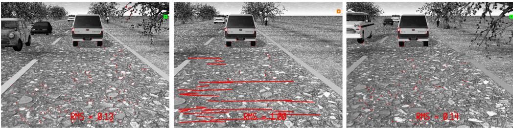
FIG. 2.14 – Affichage des distances entre appariement de points d'intérêt et appariement par stéréocorrespondance, [gauche] calibré, [milieu] décalibré, [droite] après recalibration
