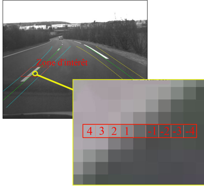
FIG. B.5 – Filtre utilisé pour la mesure du gradient
