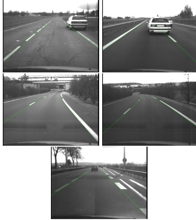
FIG. 3.1 – Robustesse aux occultations de la détection de voie (haut), aux virages (milieu) et aux sorties d'autoroute (bas).
