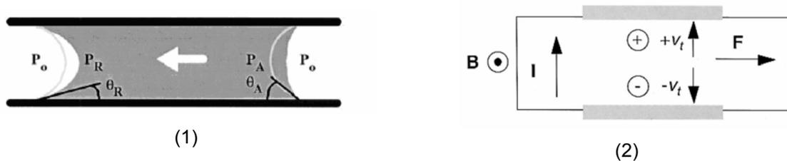
figure 44 : deux principes d'actionnement sans partie mobile (1) stress Marangoni et (2) MHD<sup>198 197</sup>
