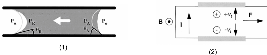
figure 44 : deux principes d'actionnement sans partie mobile (1) stress Marangoni et (2) MHD 198 197
