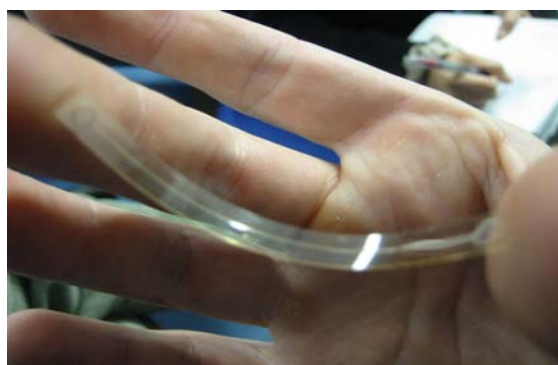
figure 97 : microcanal flexible entièrement en SU-8
