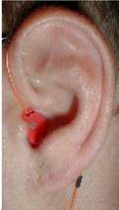
FIG. III.2 – Utilisation de moulage du conduit auditif pour le placement des microphones en conduit fermé [Vandernoot].
