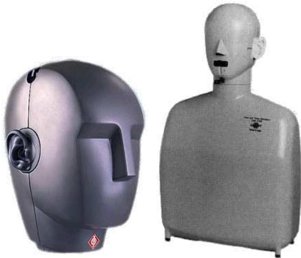
FIG. I.23 – Têtes artificielles pour la technique binaurale.
