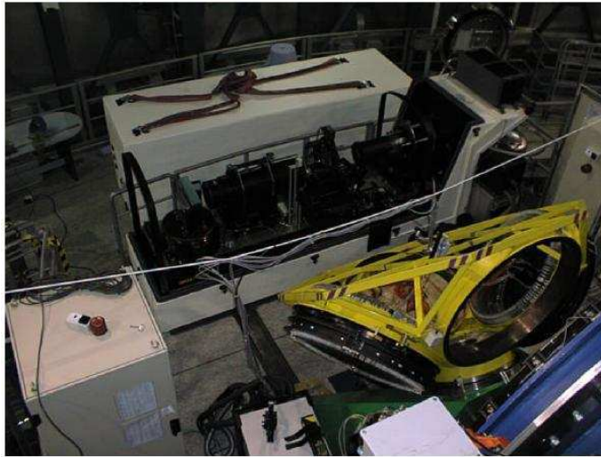
FIG. 3.6 – Vue d'ensemble de l'instrument FLAMES (extrait du manuel FLAMES, Keufer et al. 2004). Le dé-rotateur de champ du foyer Nasmyth est en partie visible en bas à droite. En jaune : le positionneur OzPoz. Au fond : le spectrographe GIRAFFE, capot ouvert. En fonctionnement normal, le positionneur est enfermé dans un capotage afin de limiter les lumières parasites.
