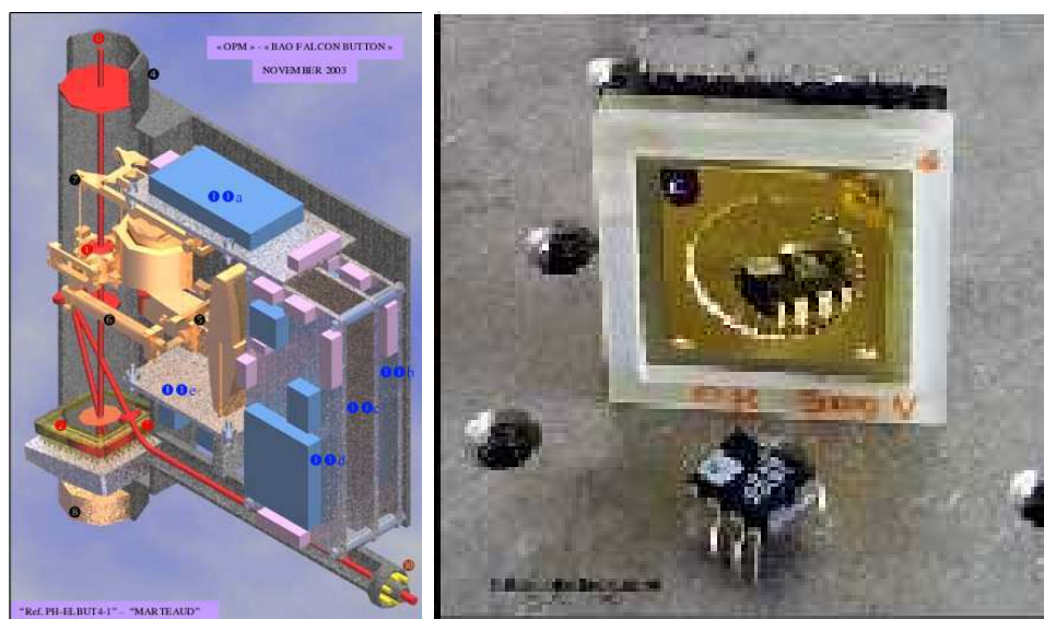
FIG. 5.12 – A gauche : design opto-mécanique d'un IFU intégrant un correcteur hybride constitué d'une lentille à 3 degrés de liberté et d'un micro-DM (Extrait de l'étude de R&D FALCON). Un tel bouton a une masse estimée à 700g et mesure 40x145x180mm. Dans le plan focal du VLT, 40 mm représentent environ 70 arcsec. A droite : micro-DM OKO à 37 actuateurs (Vdovin, 1998).
