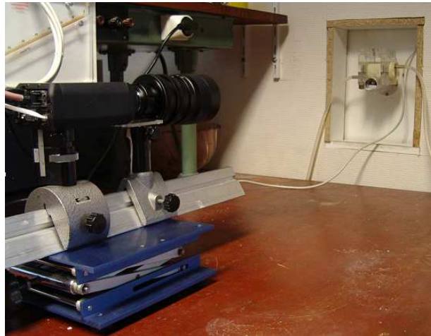
FIG. 3.6 – Dispositif expérimental de mesure de la déformation de la paroi à l'aide d'une caméra digitale. Les relevés de la caméra sont traités automatiquement à l'aide d'un logiciel dédié. Des capteurs de pression sur la paroi inférieure permettent d'obtenir à chaque pas de temps des informations sur l'écoulement qui viennent s'ajouter à l'information fournie par la caméra.
