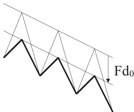
FIGURE 5.12 – Effet de la contrainte de force sur le niveau moyen de l'état de transition. En plus du gradient de potentiel qui définit un sens de migration préférentiel, la contrainte de force peut entraîner une variation du niveau moyen global de la barrière d'énergie à franchir au cours de la migration. On a fait le choix, a priori arbitraire, de représenter ici une baisse du niveau d'énergie de l'état de transition. Le paramètre d_0 est une distance caractéristique associée à l'effet de la contrainte de force.
