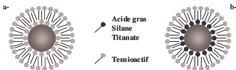
Figure III-17 : Représentation schématique d'une particule inorganique dispersée en phase aqueuse par formation (a-) d'une bicouche de tensioactif ou (b-) d'une bicouche mixte molécule hydrophobe/tensioactif
