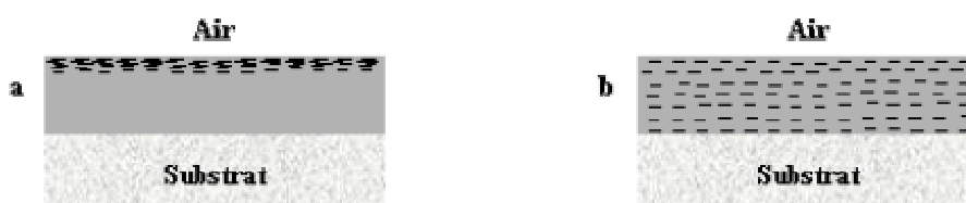
Figure I-3 : Représentation schématique de la section d'un film de peinture contenant un pigment de type pelliculant (a) et non-pelliculant (b)
