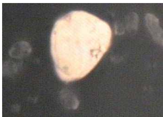
c- Cliché obtenu par microscopie optique d'un pigment encapsulé et de particules de polymère non-encapsulant
