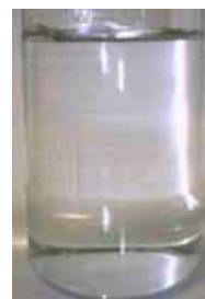
b- Tentative de dispersion en phase aqueuse de pigments recouverts d'acide stéarique (vue de profil)
