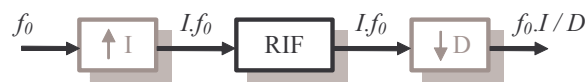
Figure 3.15. Utilisation d'un filtre RIF direct pour la mise en place d'un système de CFE.
