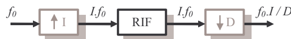
Figure 3.15. Utilisation d'un filtre RIF direct pour la mise en place d'un système de CFE.
