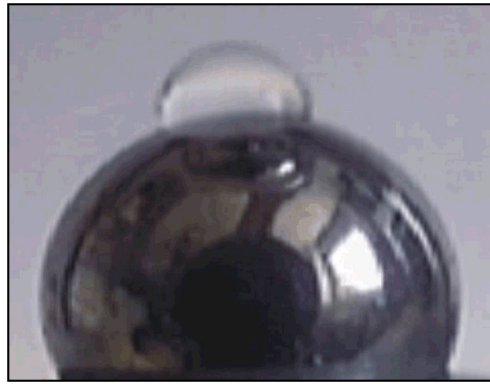
FIG. 3.2: Formation de gouttes à la surface des grains après la rupture d'un pont liquide
