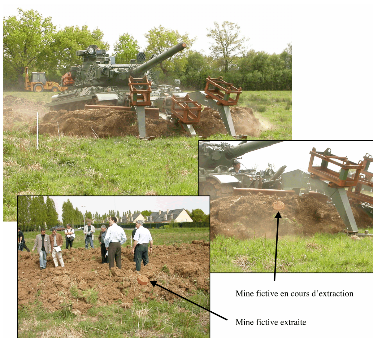
FIG. 1.1: Processus de déminage par scarification. Essais en vraie grandeur réalisés à l'Etablissement Technique d'Angers (ETAS)
