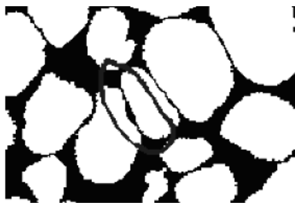
Figure 110 – Illustration d'un contact double. Une zone de contact entre deux grains où l'un des grains présente une partie concave sur la zone de contact est entourée. Une seule zone de contact doit être extraite, alors que la différence directe entre l'image binaire de départ et l'image des grains séparés nous en donne deux. Coupe 2D extraite de l'échantillon 1,2 g 60 Hz.
